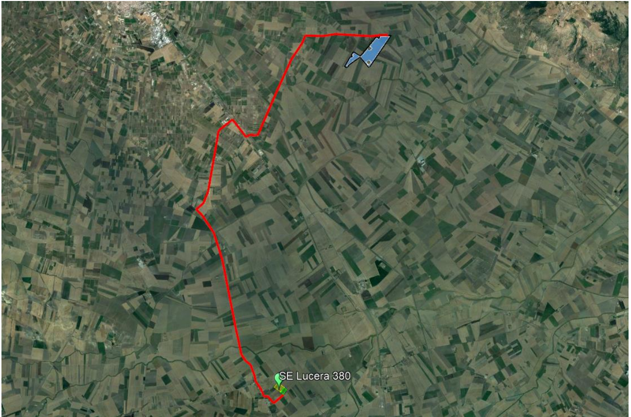
Fig. 2 – Tracciato cavidotto MT verso SE
