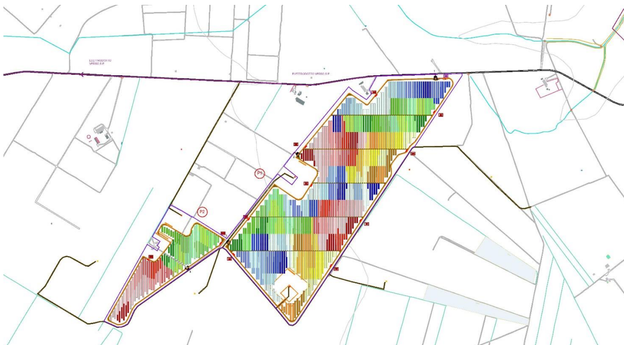
Figura 4- Particolare schema di suddivisione stringhe impianto
