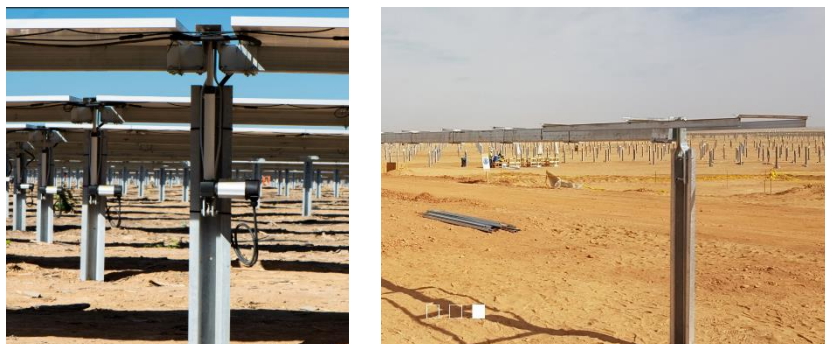
Figura 5 - Particolare strutture ad inseguimento ed attuatore
