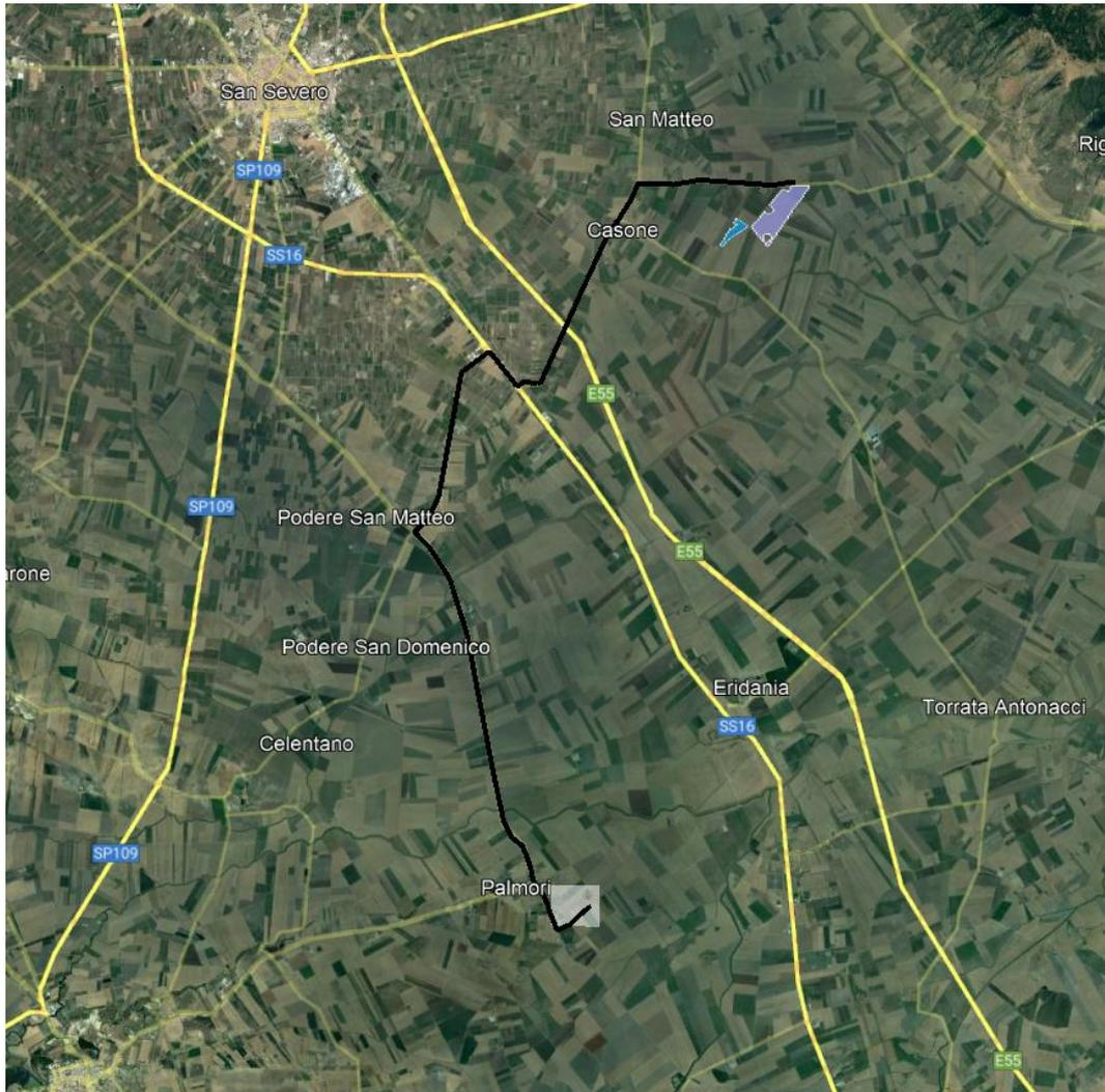
*Figura 33 - Tracciato del cavidotto MT esterno verso la nuova SE*
