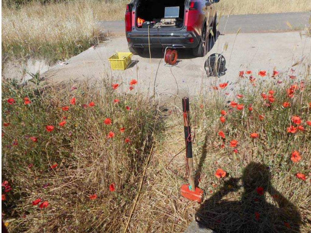
Fig. 3.2 Attrezzatura utilizzata Sismografo Ambrogeo ECHO 12-24 con Geofoni 4.5 Hz, energizzazione con mazza da 9 Kg su piattello metallico
