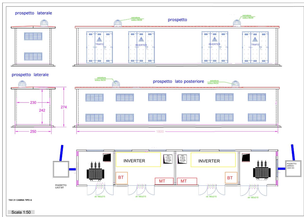
Figura 3 Cabina di trasformazione Tipo A
