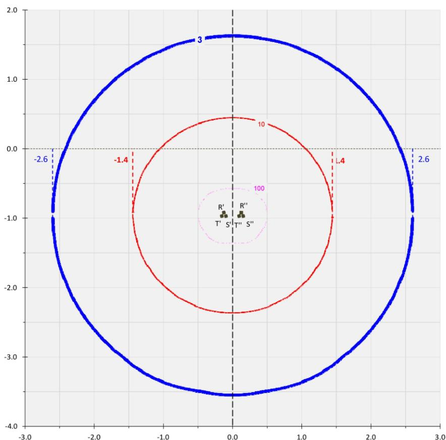
Figura 11 Curve equipotenziali di induzione da cavo MT a trifoglio alla massima corrente
