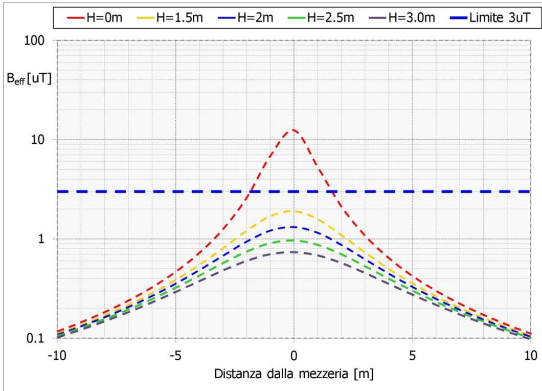
Figura 10 induzione magnetica da linea in cavo alla massima corrente
