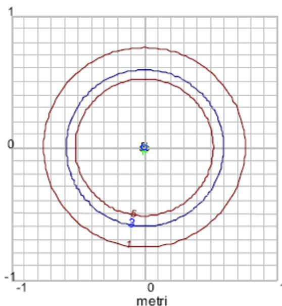
Figura 5 Curve equipotenziali linea MT sotterranea cavo cordato a elica
