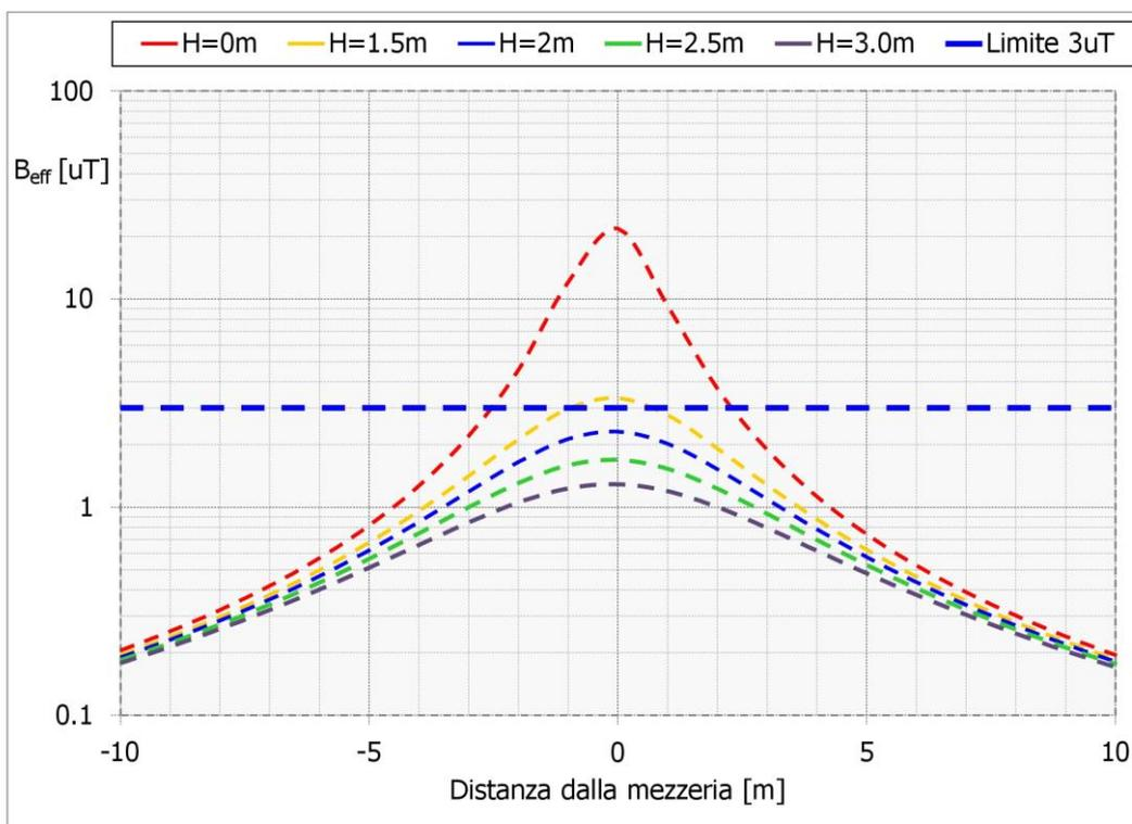
Figura 9 induzione magnetica da linea in cavo alla massima corrente
