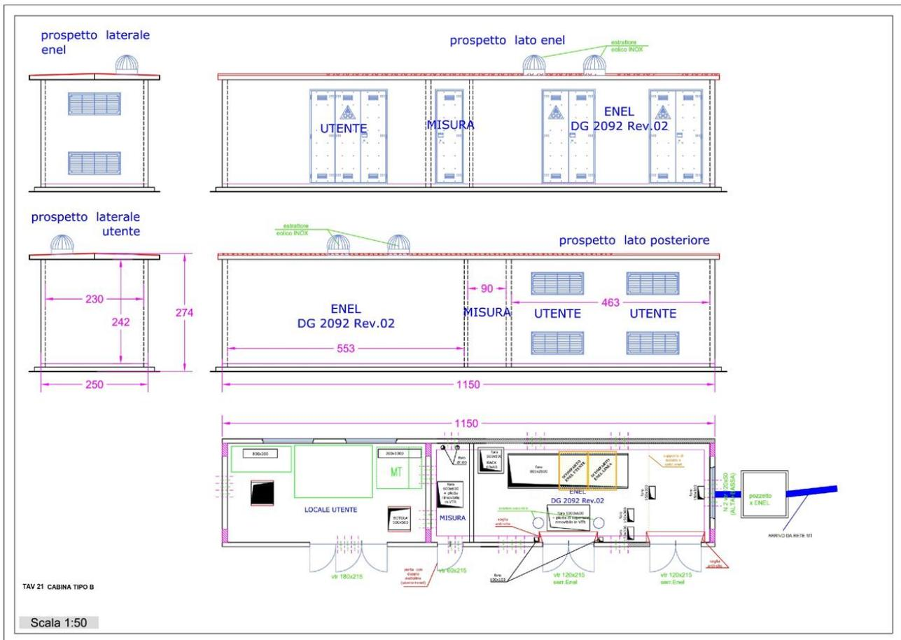
Figura 4 Cabina di trasformazione Tipo A
