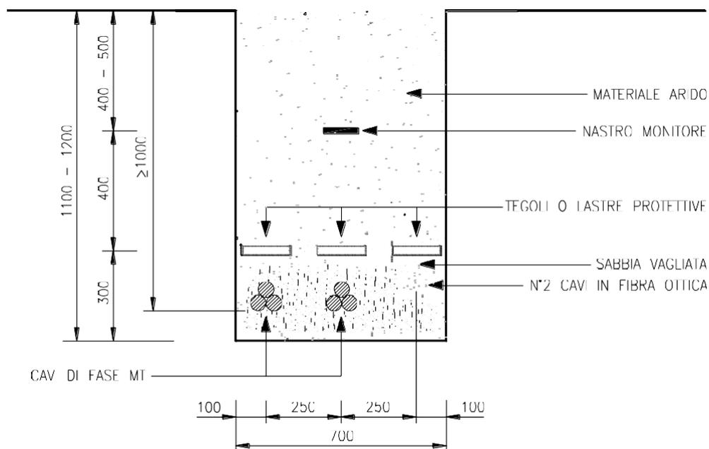
Figura 7 Sezione di posa cavi su terreno vegetale
