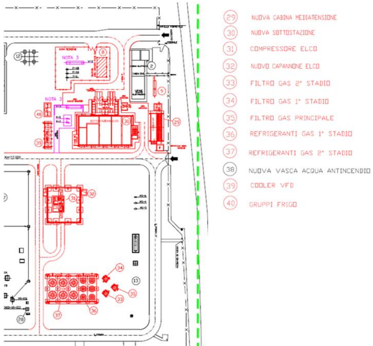
Figura 2.4-1: Estratto planimetria generale Centrale di Settala e posizionamento del nuovo elettrocompressore ed i relativi impianti accessori
