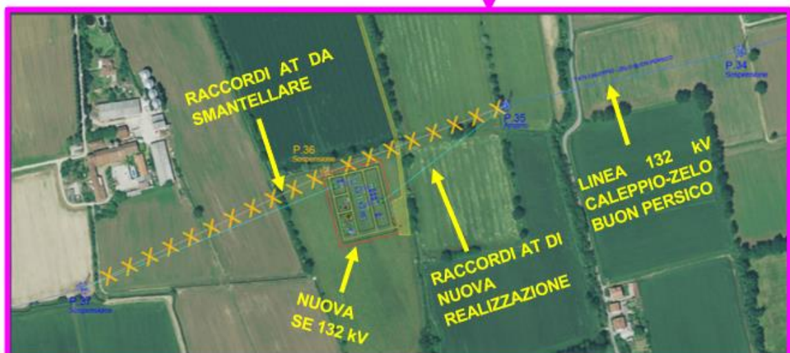
Figura 2.1-2: Territorio oggetto di indagine ed inserimento della nuova SE 132 kV e relativi raccordi aerei AT di connessione alla linea "Caleppio-Zelo Buon Persico"
