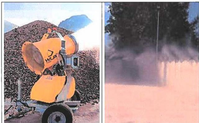
*Sistemi di bagnatura delle aree di cantiere e depositi: cannoni (sx), nebulizzatori (dx).*
