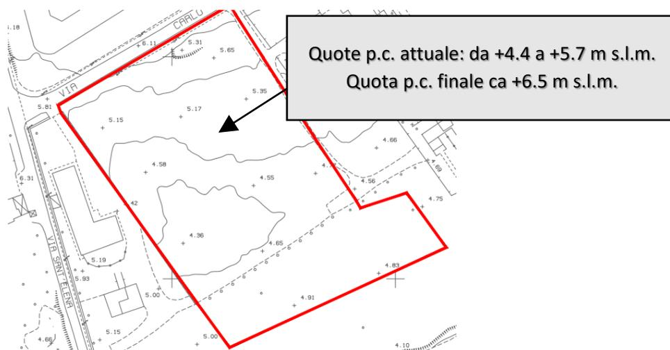
Rilievo aerofotogrammetrico del sito di destino e indicazione delle quote finali a valle del riutilizzo per ricomposizione morfologica
