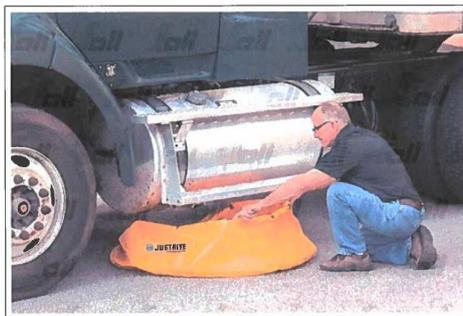
Vasche per il contenimento di sversamenti di mezzi d'opera
