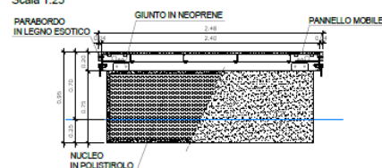
Figura 24 Pianta, vista laterale e trasversale tipologia dei pontili. Estratto dalla tavola B15
