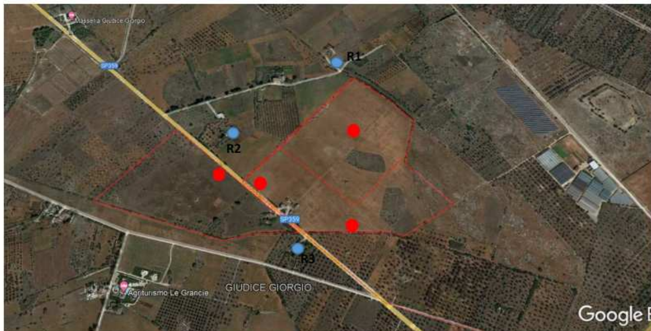
Indicazione dei ricettori (pallini azzurri) e delle cabine di trasformazione BT/MT (pallini rossi)
