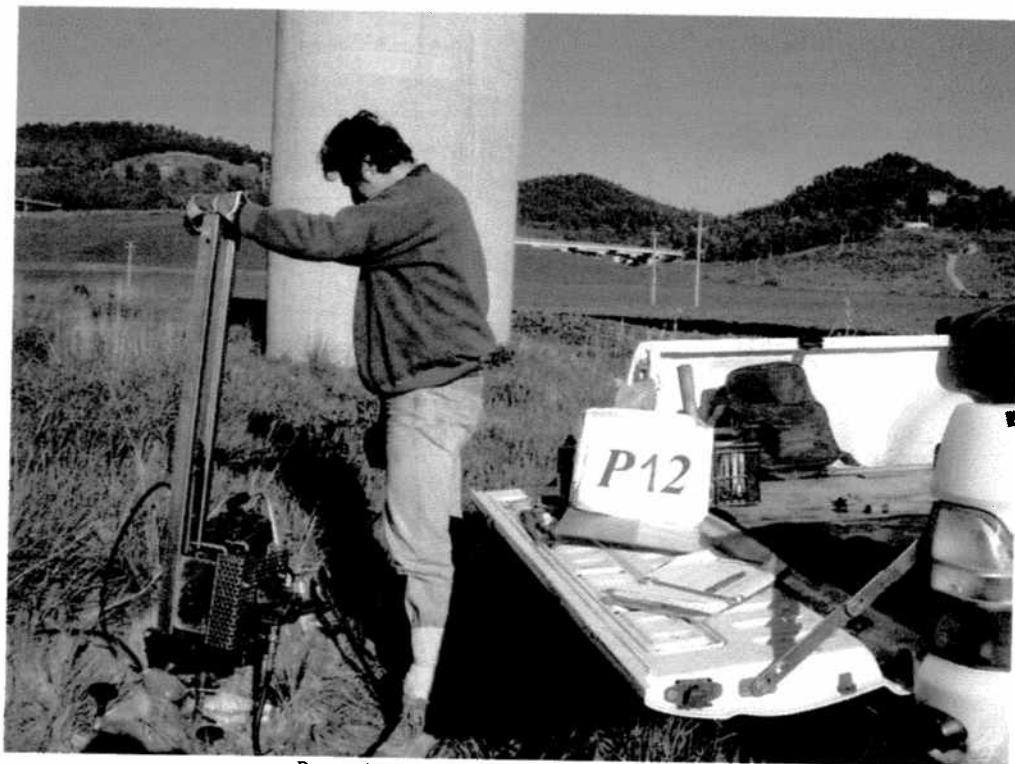
Postazione prova penetrometrica CPT12
