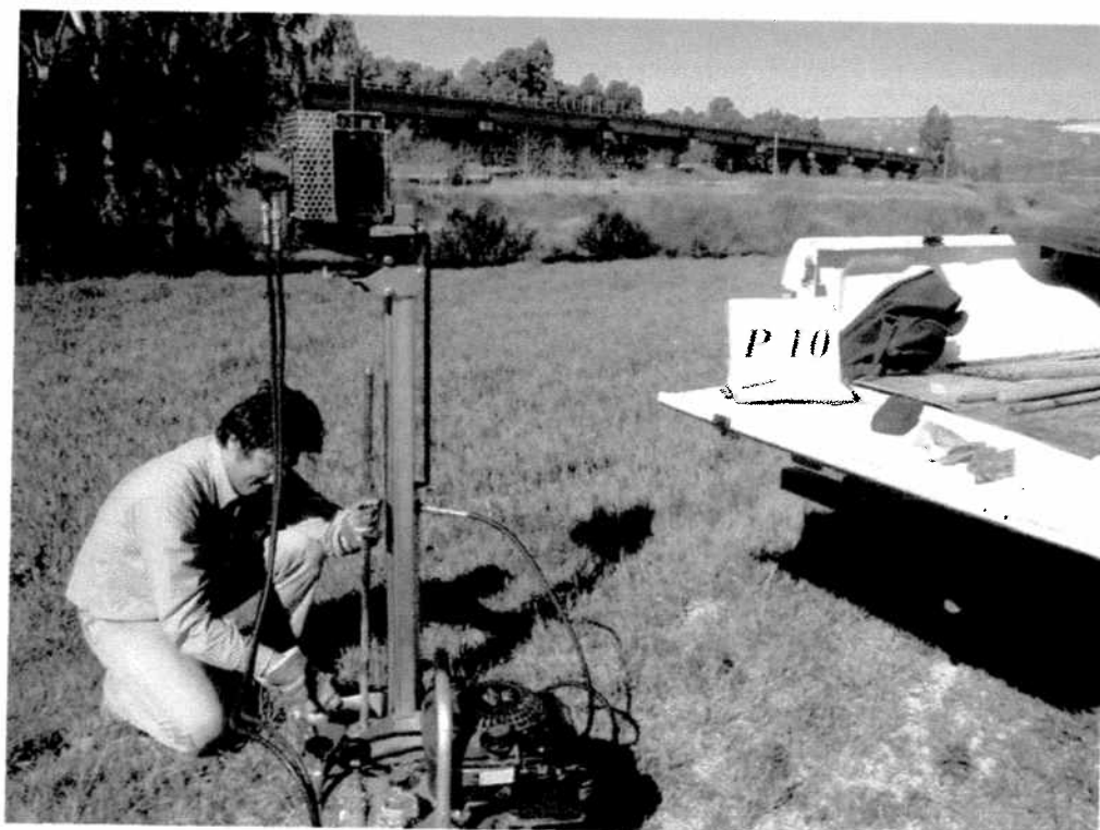
Postazione prova penetrometrica CPT10
