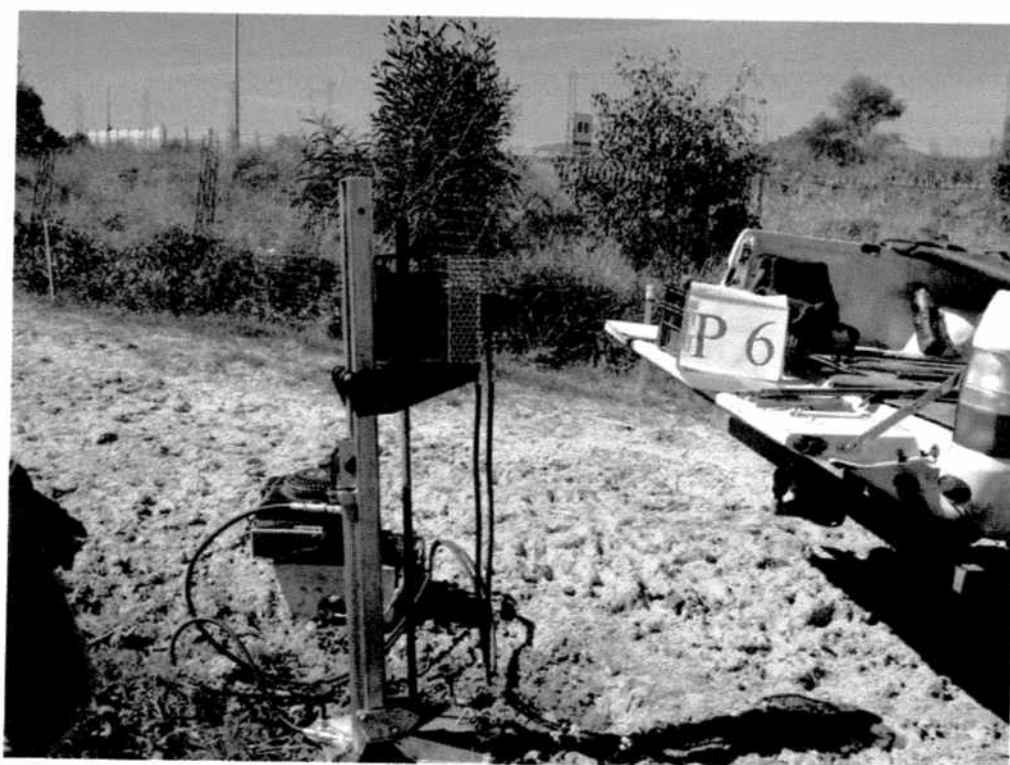
Postazione prova penetrometrica CPT6
