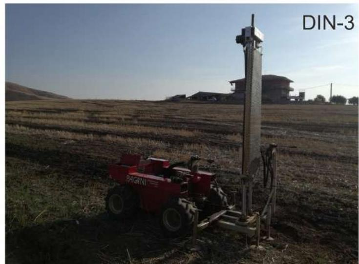
Foto 3 – Piazzamenti delle indagini penetrometriche dinamiche
