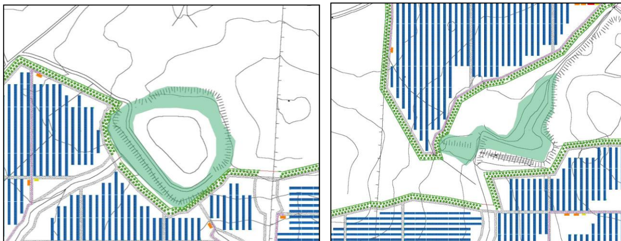
Figura 6| Layout di impianto confinante alle aree interessate dall'habitat 6220* (in verde): in rosso la recinzione che circonda l'area di impianto seguita dalla fascia di mitigazione e dal posizionamento del generatore fotovoltaico
