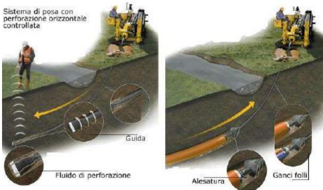
Posa in opera tubazione con trivellazione teleguidata
