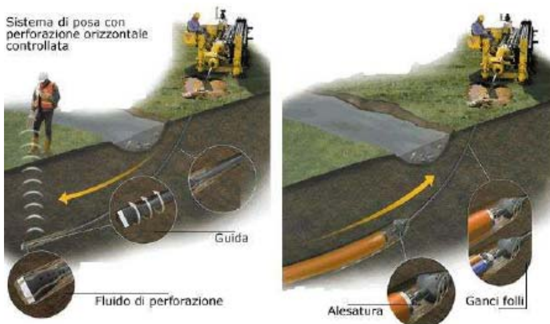
Posa in opera tubazione con trivellazione teleguidata
