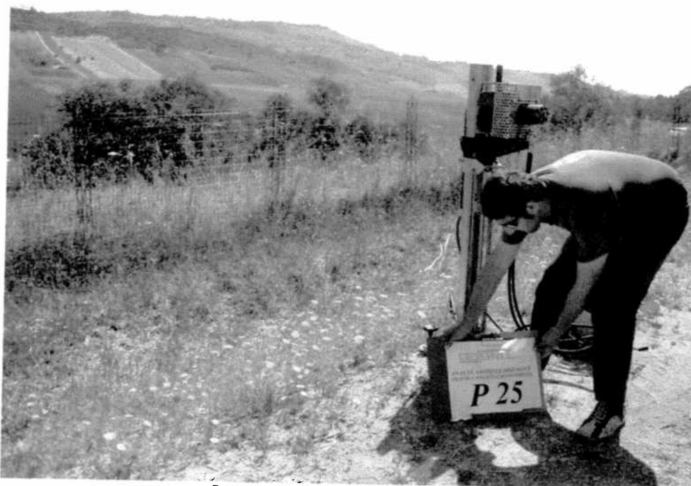
Postazione prova penetrometrica P25
