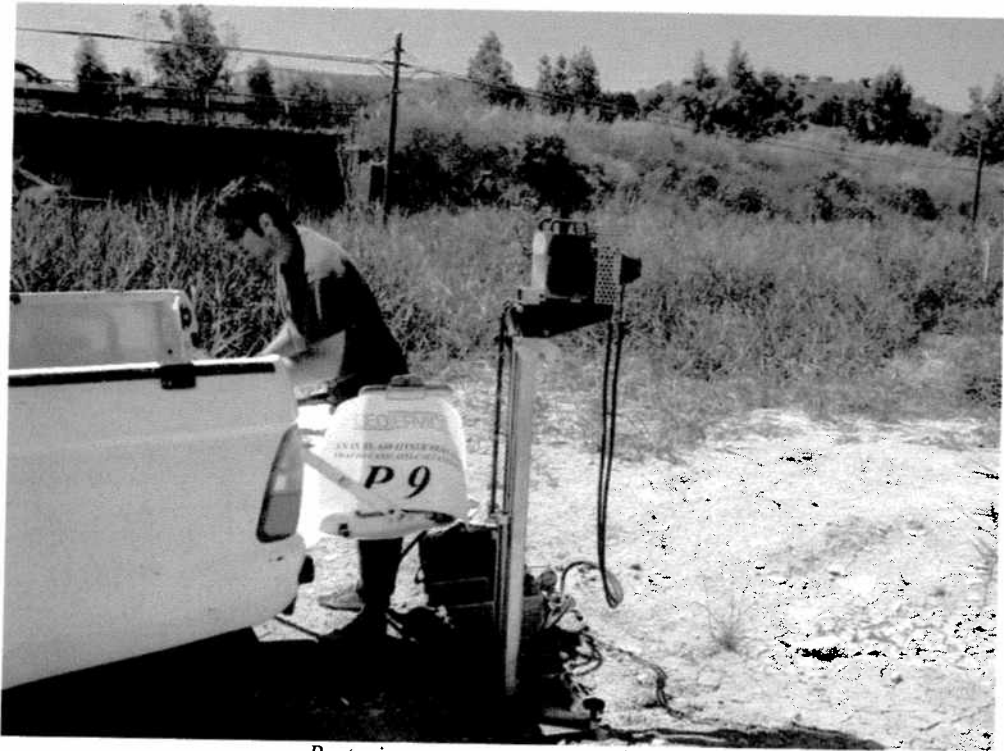
Postazione prova penetrometrica P9
