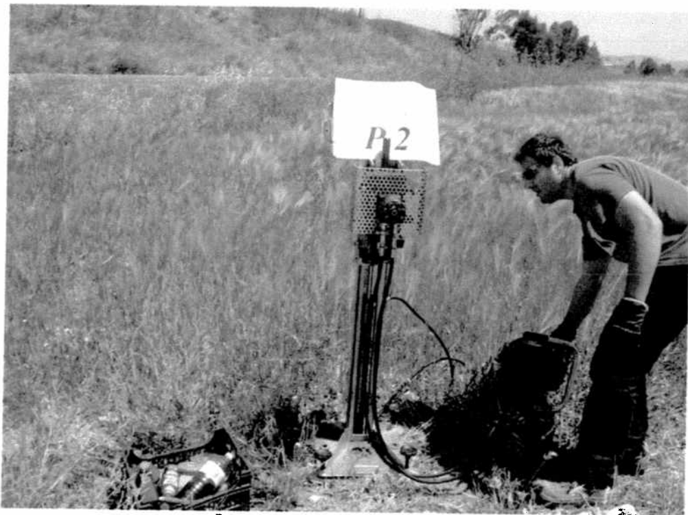
Postazione prova penetrometrica P2
