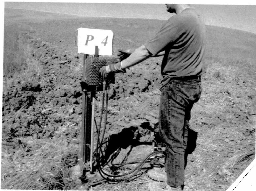
Postazione prova penetrometrica P4
