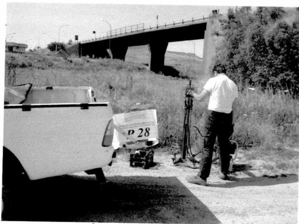
Postazione prova penetrometrica P28
