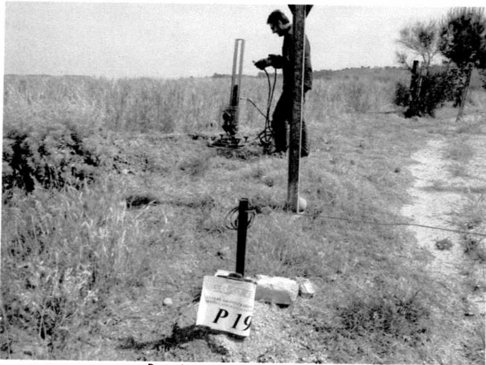
Postazione prova penetrometrica P19
