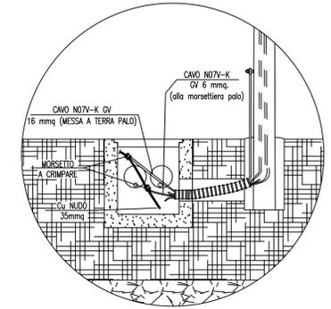
Sezione scavo di illuminazione perimetrale e dati scala 1:25
