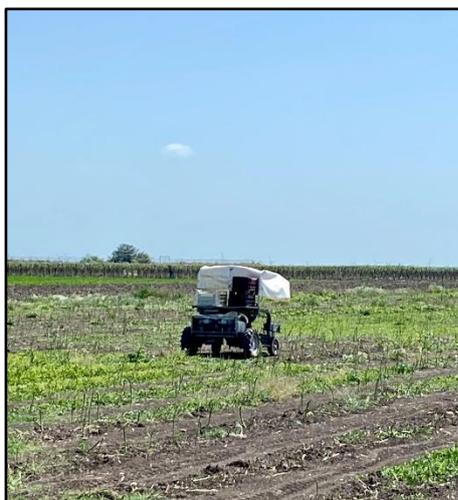
*Figura 21 - Macchina raccogliitrice di asparagi in funzione*
