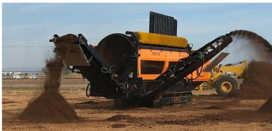
*Esempio di vaglio montato su cingoli con carico autonomo*
