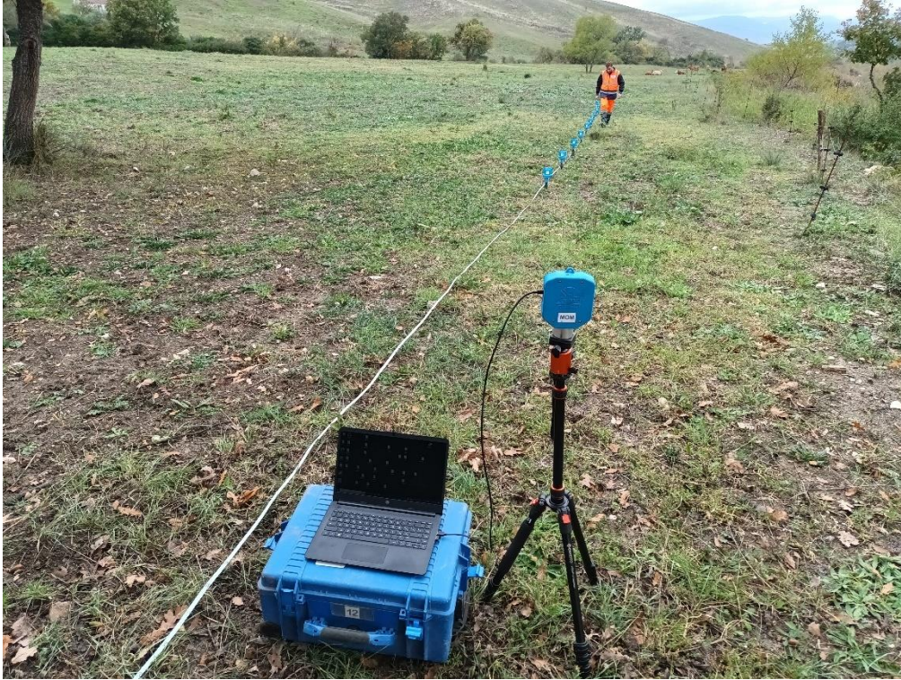
Postazione della MASW 01
