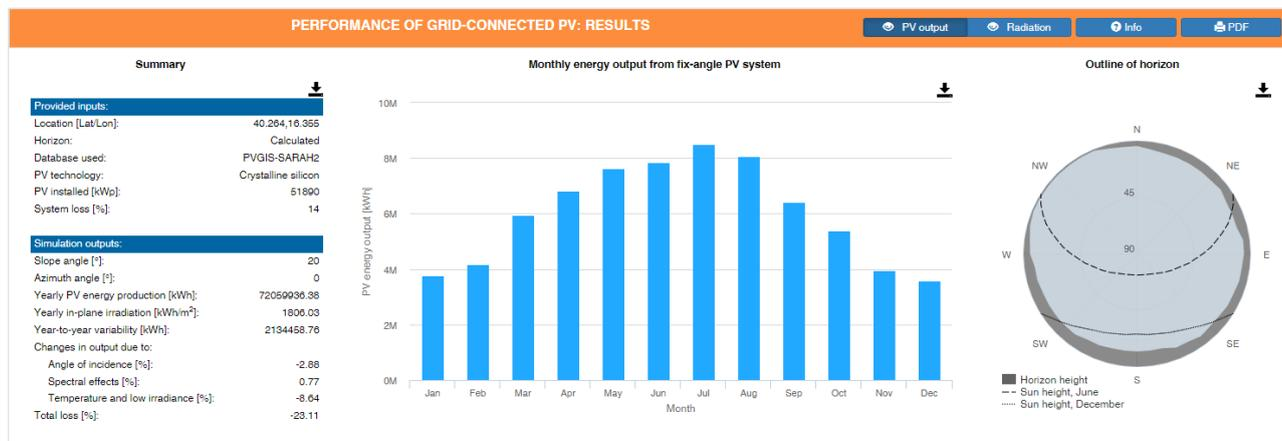
Figura 4.5a. – Simulazione di produttività annua del sistema Agrivoltaico.
