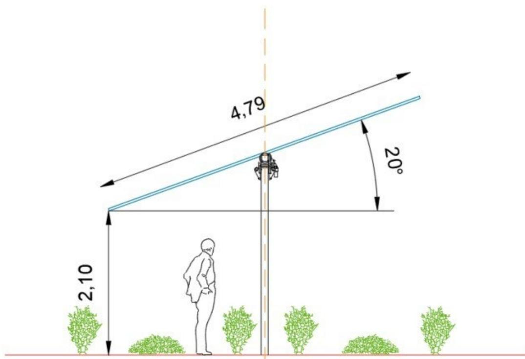
Figura 2.2. – Area di insidenza minima del modulo fotovoltaico.
