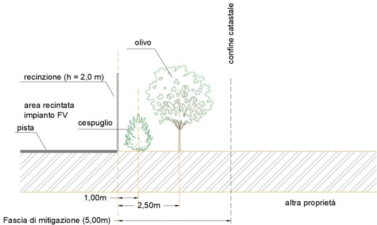
Figura 2.11. – Stralcio di sezione dell'area perimetrale dell'impianto.
