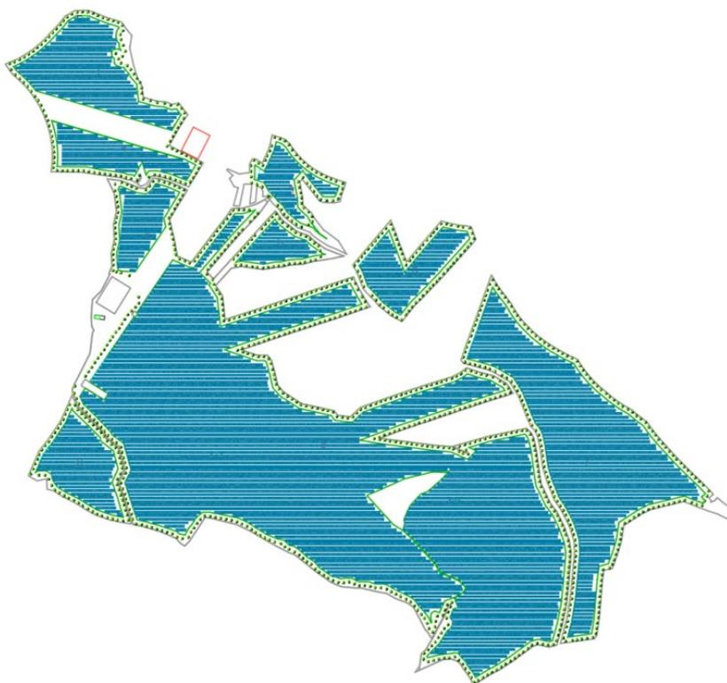
Figura 4.2. – Layout del sistema fotovoltaico standard.
