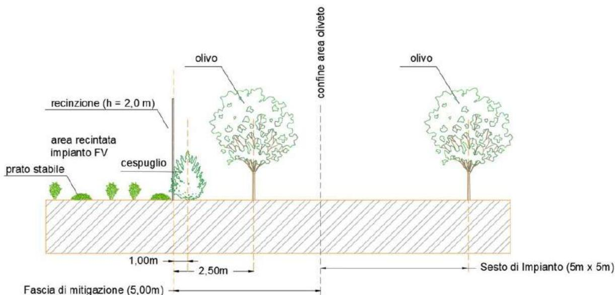
Figura 2.12. – Stralcio di sezione dell'area perimetrale dell'impianto.
