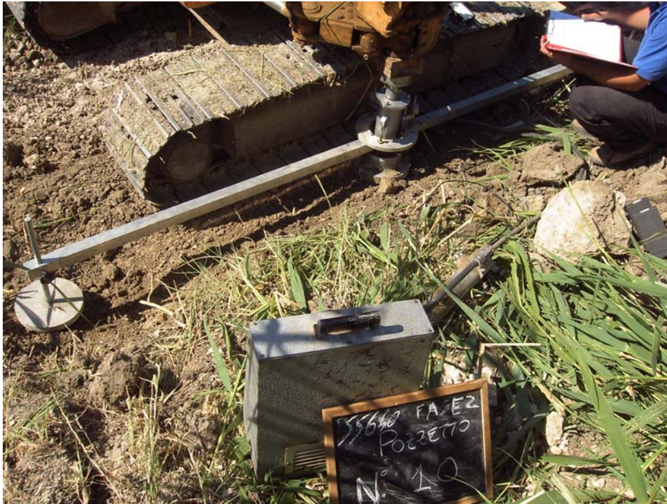
Prova di carico su piastra - pozzetto 10
