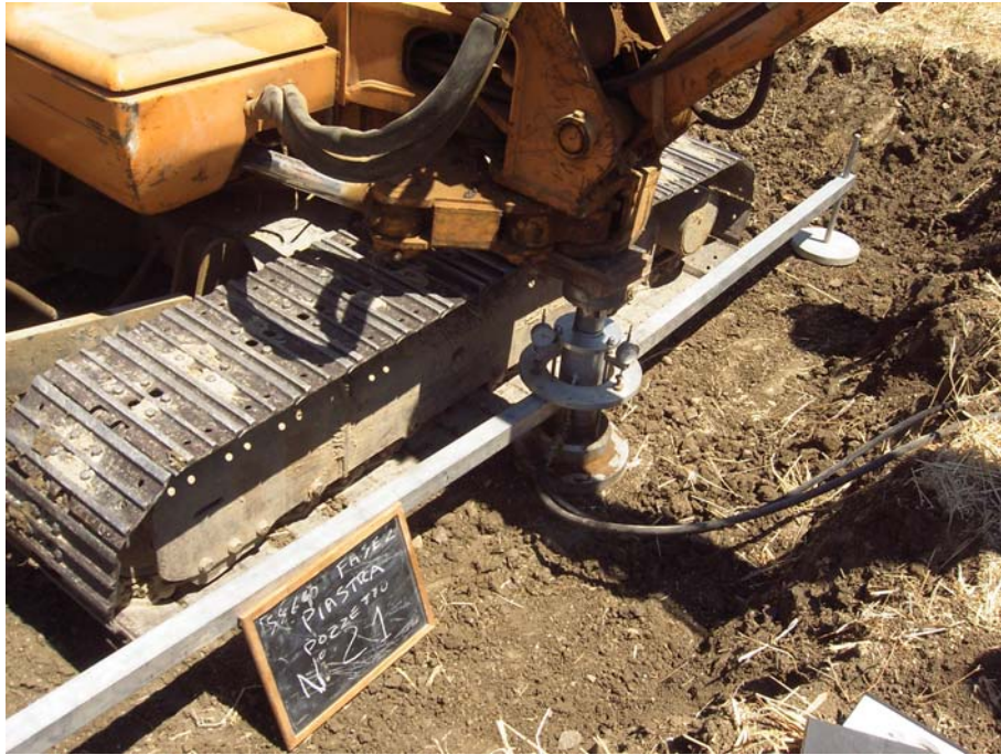
Prova di carico su piastra - pozzetto 21
