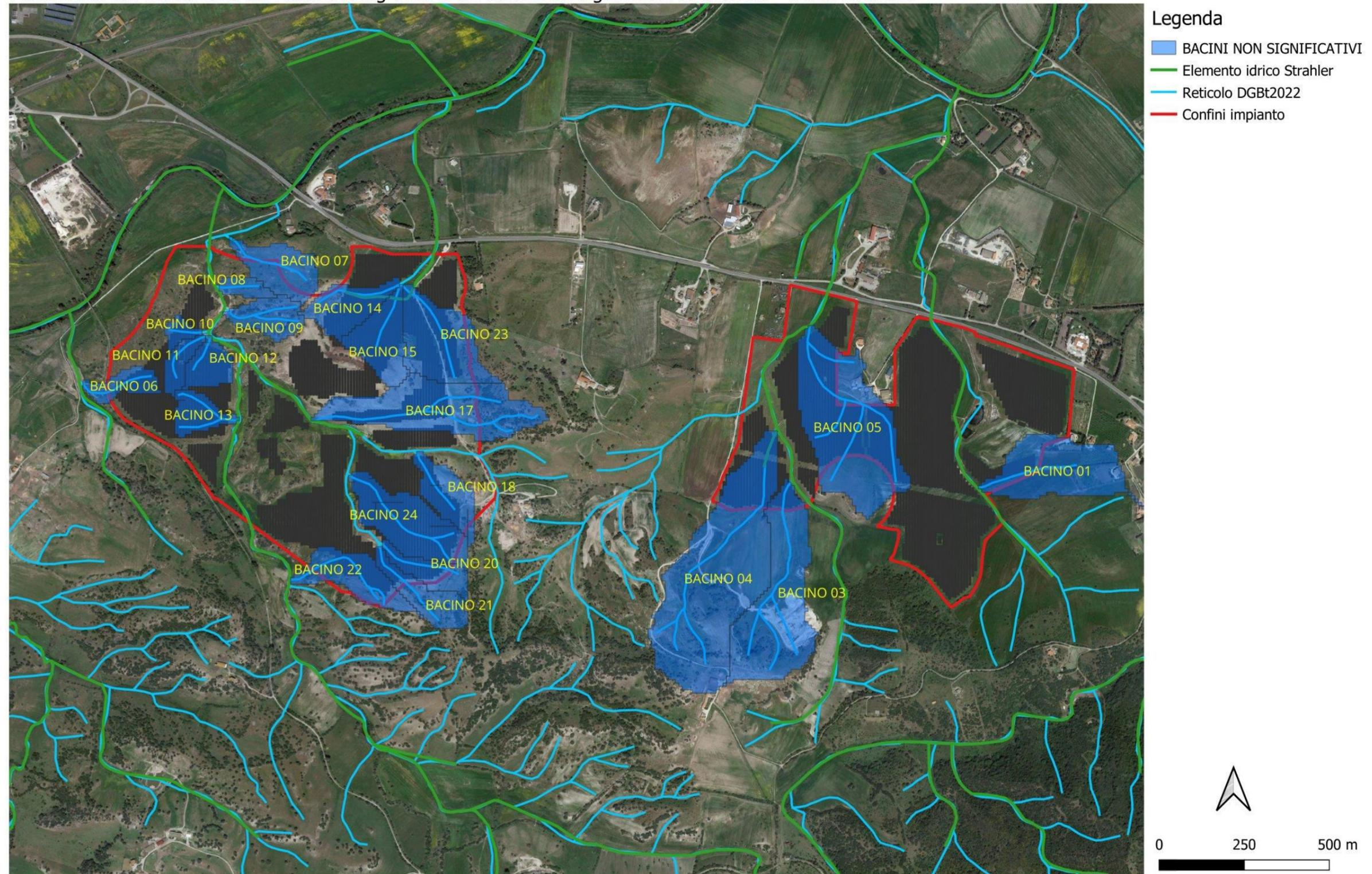
Figura 4-1 Bacini idrologici con sezione di chiusura corrispondenza della sezione di confluenza dell'elemento a valle
