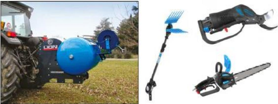
**Figura 16: Compressore PTO per il funzionamento di strumenti pneumatici per l'arboricoltura**
