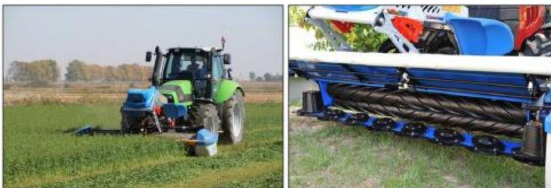
**Figura14: Esempio di falciacondizionatrice frontale e particolare dei rulli in gomma**
