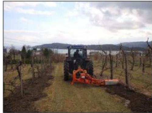
**Figura 8: Esempio di fresatrice interceppo per le lavorazioni sulla fila**
