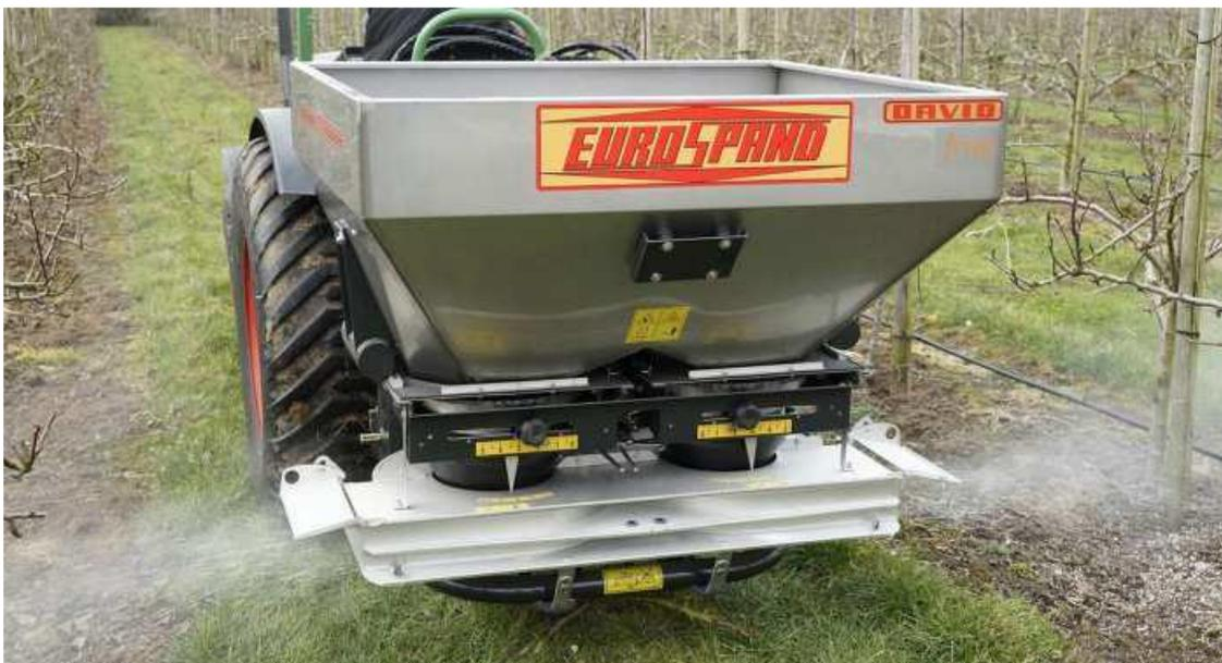
**Figura 17: Esempio di spandiconcime localizzato mono/bilaterale per frutteti**
