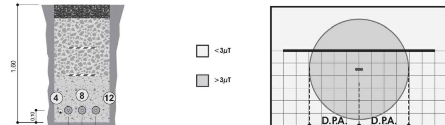
D.P.A - SEZIONI CAVI COLLEGAMENTO CABINA CONCENTRAZIONE-RTN
