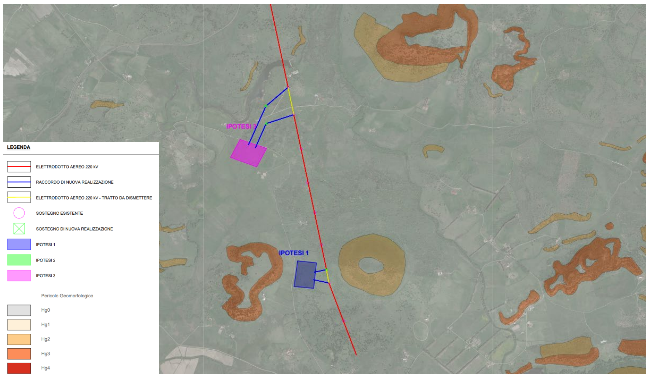
Figura 4 - Inquadramento Ipotesi 1 e 3 per la nuova SE RTN su cartografia PAI – Pericolo geomorfologico
