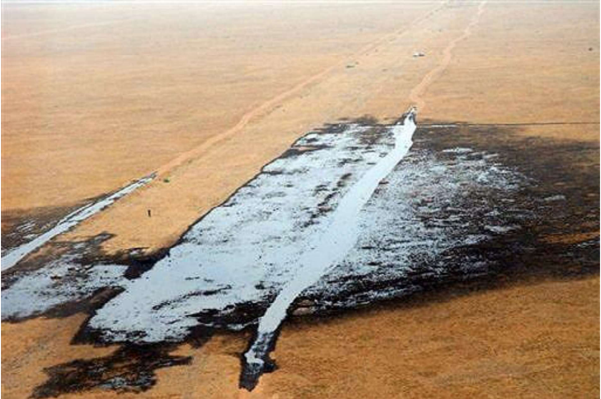
Fig. 14 - L'oleodotto interrato scoppiato vicino a Marsiglia (Francia) nell'Agosto 2009, rilasciando circa 4.000 litri di idrocarburi con grossi zampilli su una riserva naturale.
