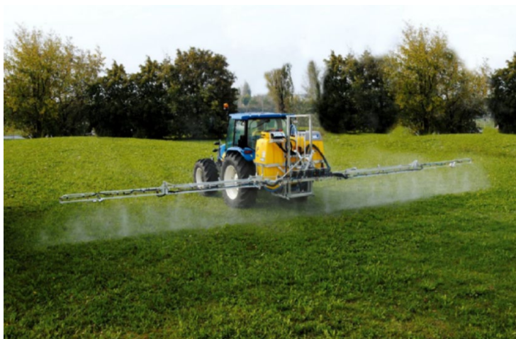
Figura 13 - Barra irroratrice con ugelli antideriva
