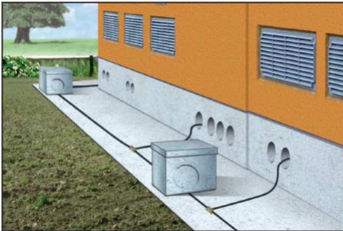
Rappresentazione di una tipica cabina di raccolta secondo DG2061: particolari di condutture e realizzazione di impianto di terra locale
