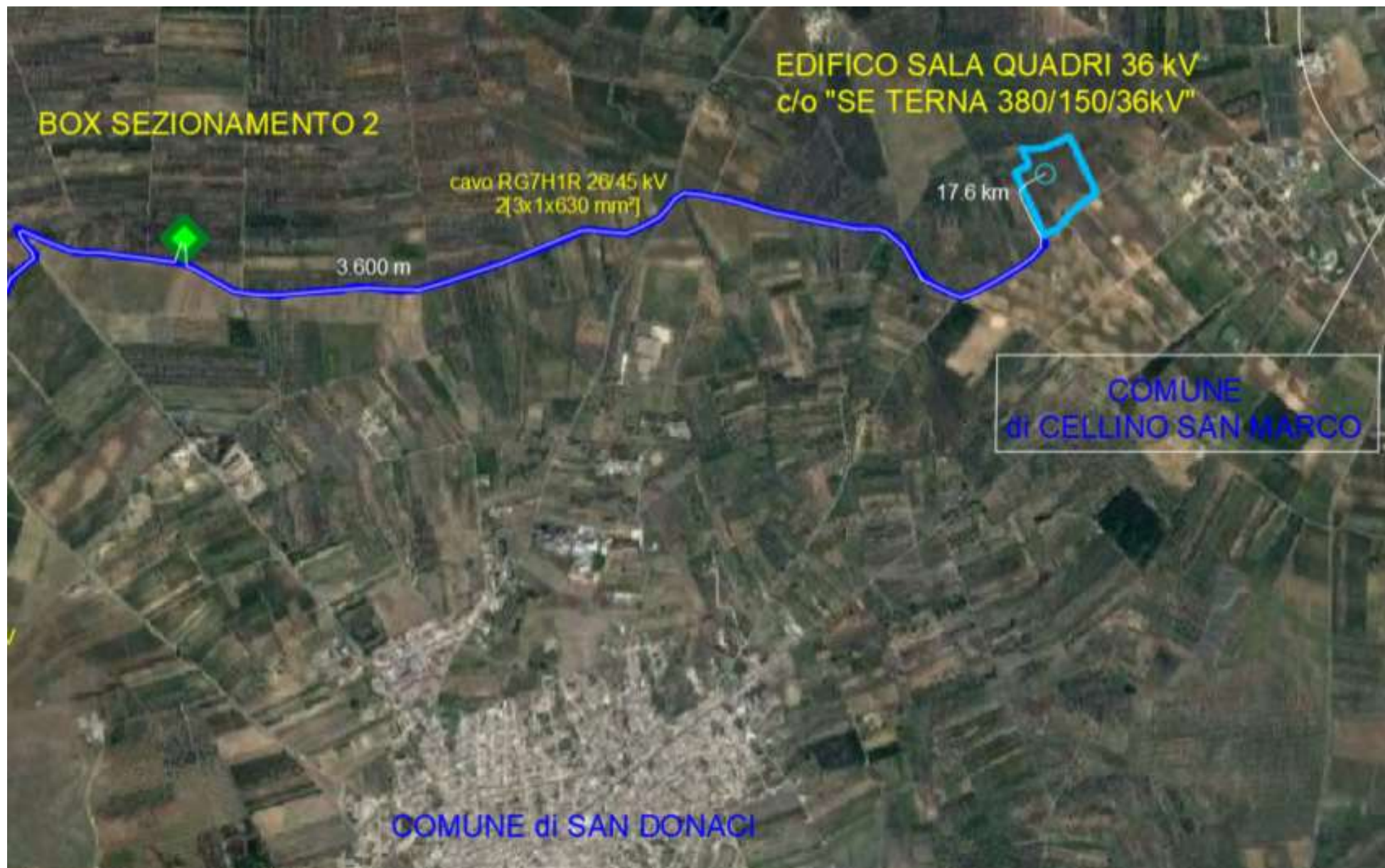
Tratto 5: da Box di sezionamento 2 a immissione in Sala Quadri 36 kV della SE 380/150/36 kV di Cellino San Marco
