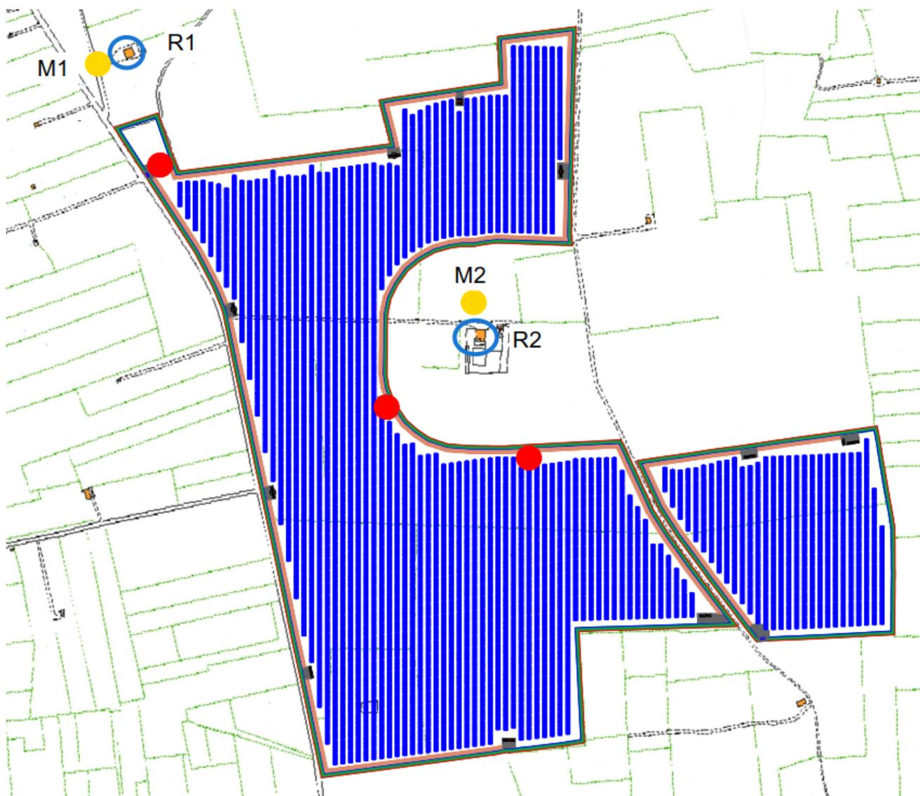
**AREA 1:** Indicazione dei ricettori (pallini azzurri), delle cabine inverter e di trasformazione BT/MT (pallini rossi), dei punti di misurazione di  $Leq(A)$  (pallini gialli)
