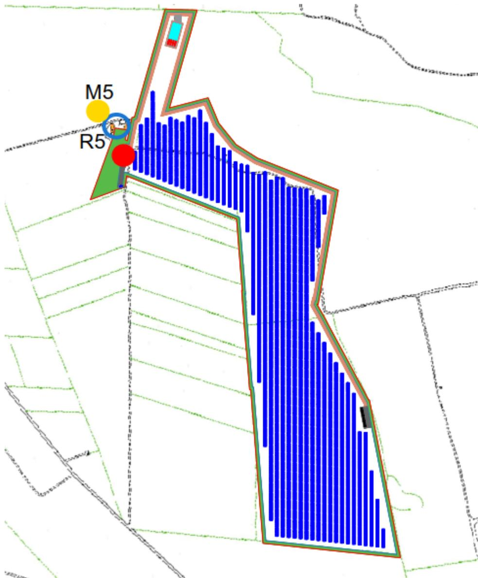
**AREA 3:** Indicazione dei ricettori (pallini azzurri), delle cabine inverter e di trasformazione BT/MT (pallini rossi), dei punti di misurazione di Leq(A) (pallini gialli)
