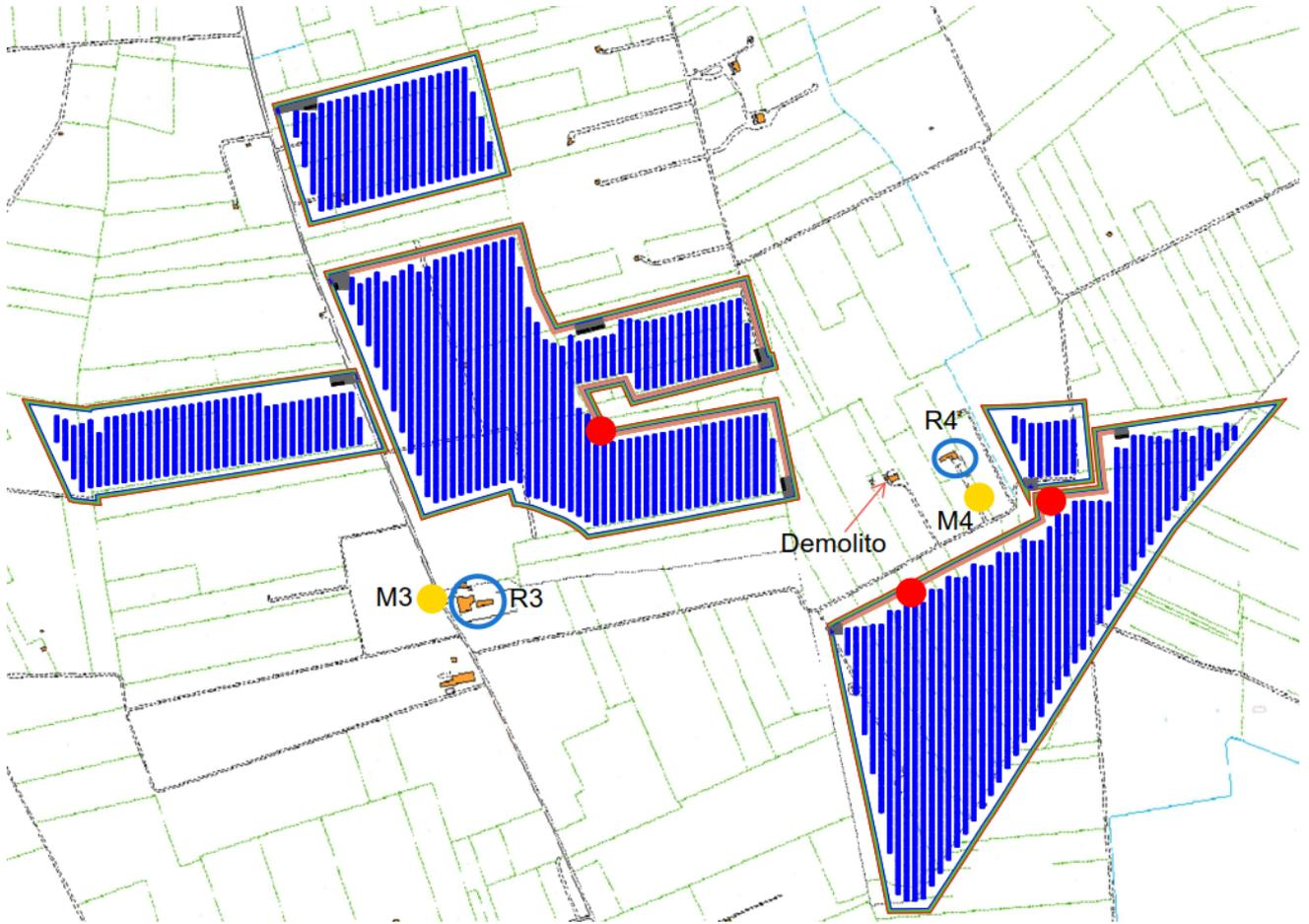
**AREA 2:** Indicazione dei ricettori (pallini azzurri), delle cabine inverter e di trasformazione BT/MT (pallini rossi), dei punti di misurazione di  $Leq(A)$  (pallini gialli)
