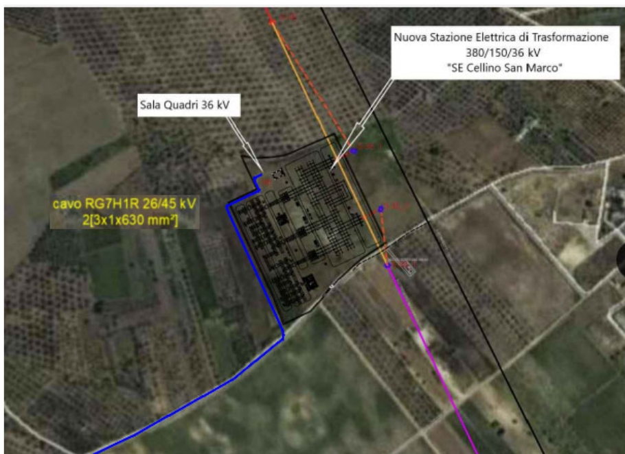
Figura 6: Ubicazione della Stazione Elettrica
