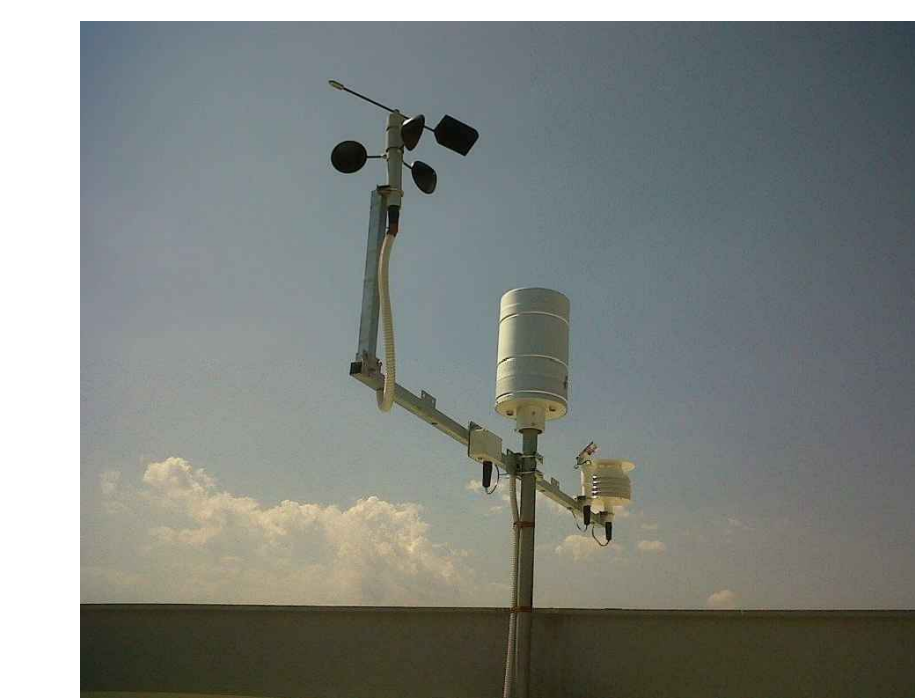
Centraline di controllo parametri microclimatici per lo studio del clima in esercizio dell'impianto
