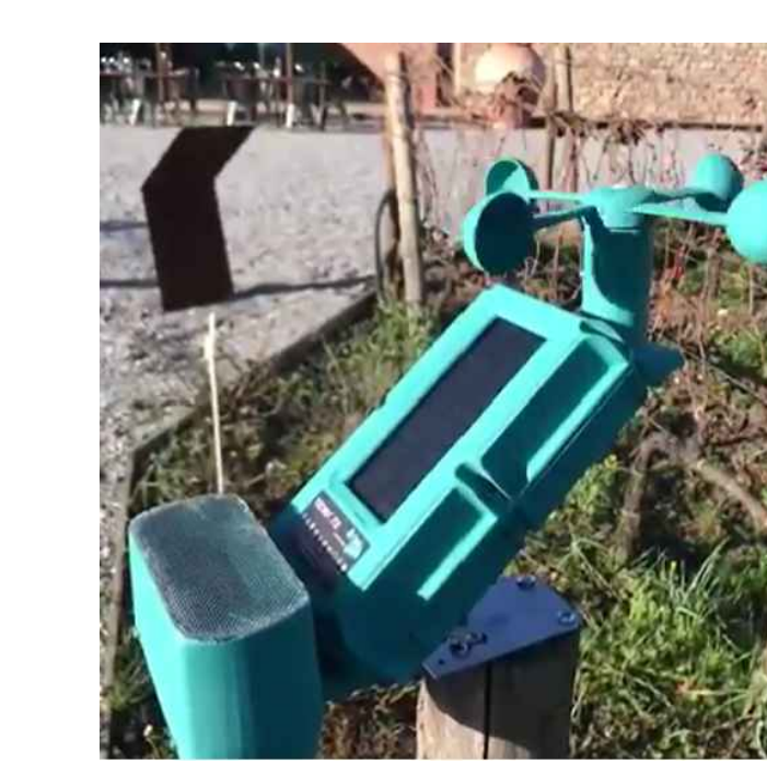
Sistema di sensoristica diffusa che permette di verificare da remoto le micro-dinamiche dei campi coltivati.
