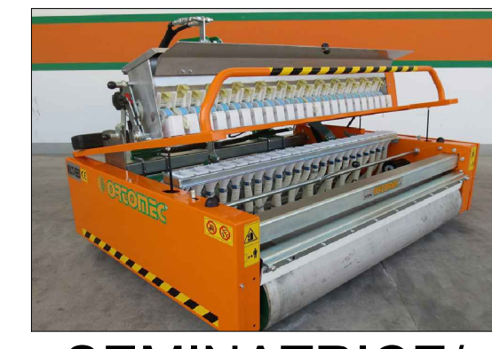
SEMINATRICE/ RACCOLTRICE larghezza: 2,00 mt max altezza: 1,80 mt max lunghezza: 2,20 mt max
