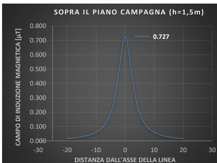
**Figura 7: campo elettromagnetico a 1,5 m sopra il suolo**
