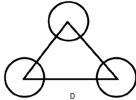
Figura 6: configurazione a trifoglio di tre conduttori
