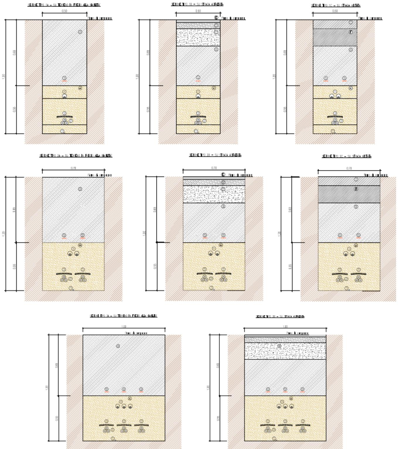
Figura 2: sezioni tipo cavidotti
