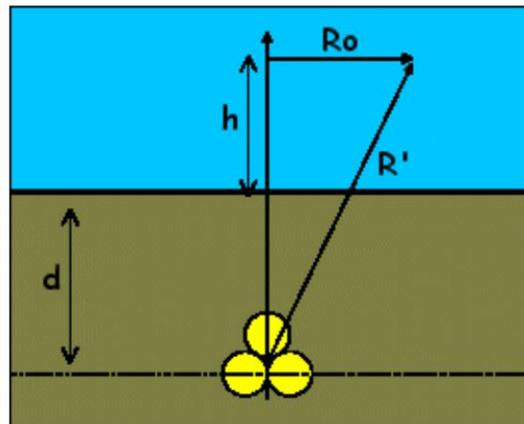
Figura 10: Schema e distanze di cavi interrati posati a triangolo (CEI 106-11)
