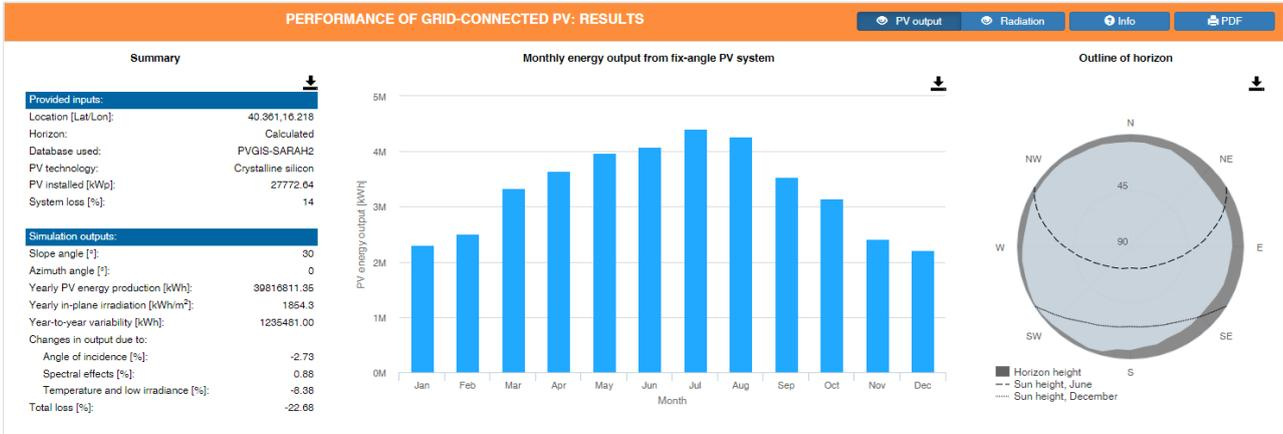
Figura 4.6. – Rendimento dell’impianto e delle caratteristiche tecnico-produttive impianto standard.
