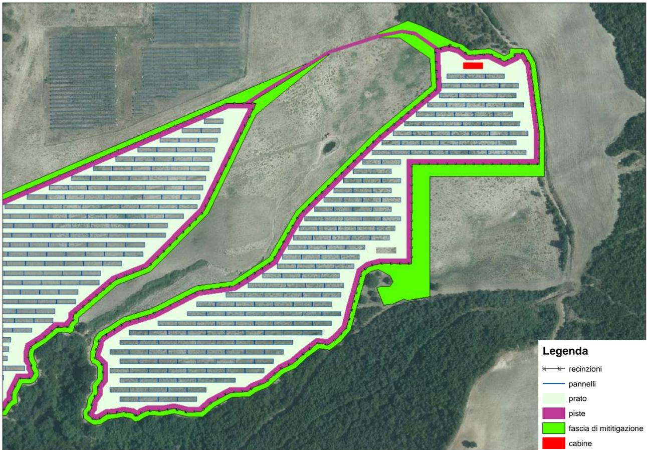
Figura 2.3.a – Area di progetto con indicazione del posizionamento dei moduli fotovoltaici-dettaglio
