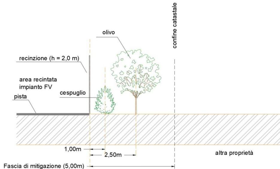
Figura 2.12. – Stralcio di sezione dell'area perimetrale dell'impianto.
