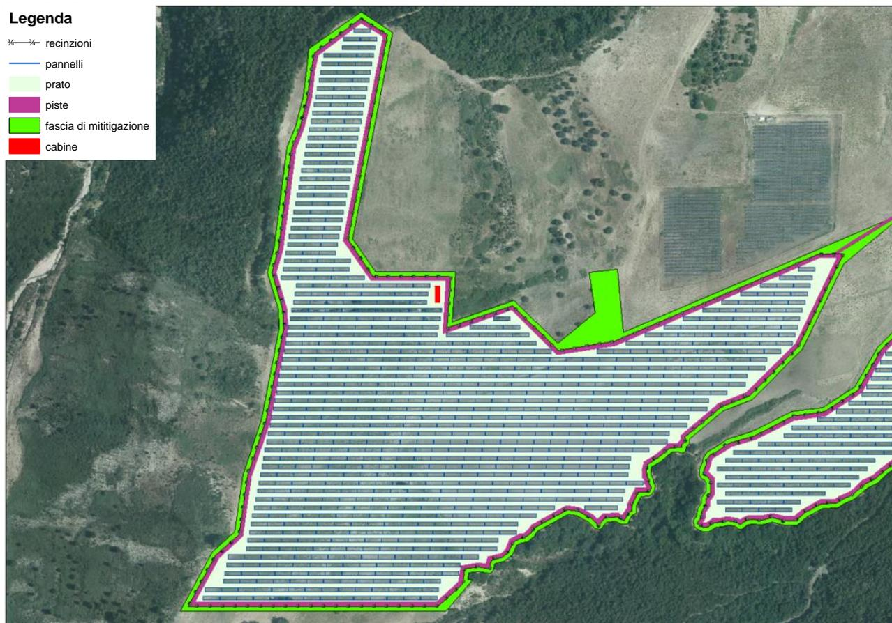
Figura 2.3.b – Area di progetto con indicazione del posizionamento dei moduli fotovoltaici-dettaglio
