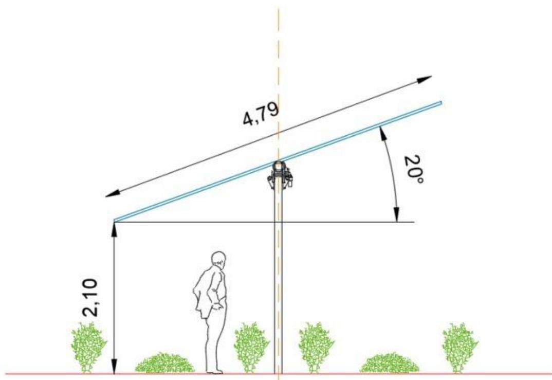
Figura 2.2. – Area di insidenza minima del modulo fotovoltaico.
