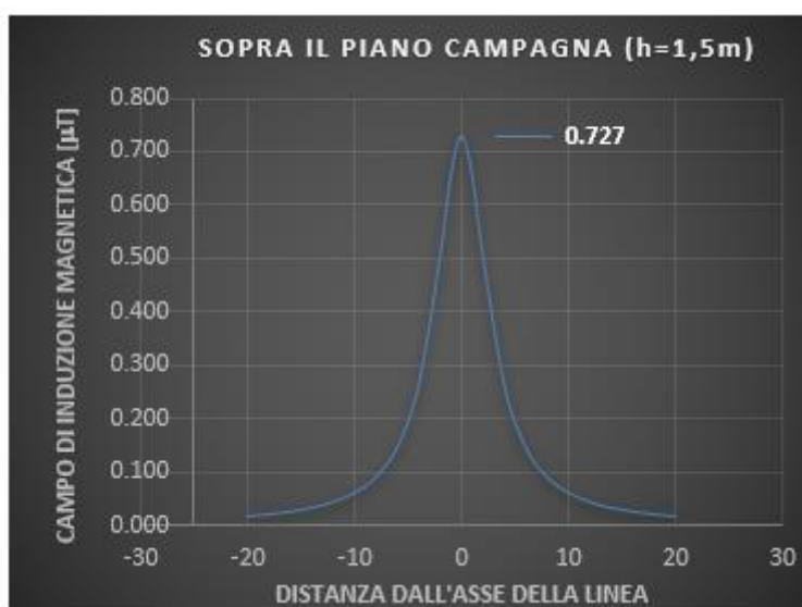
Figura 56 - Campo elettromagnetico a 1,5 m sopra il suolo
