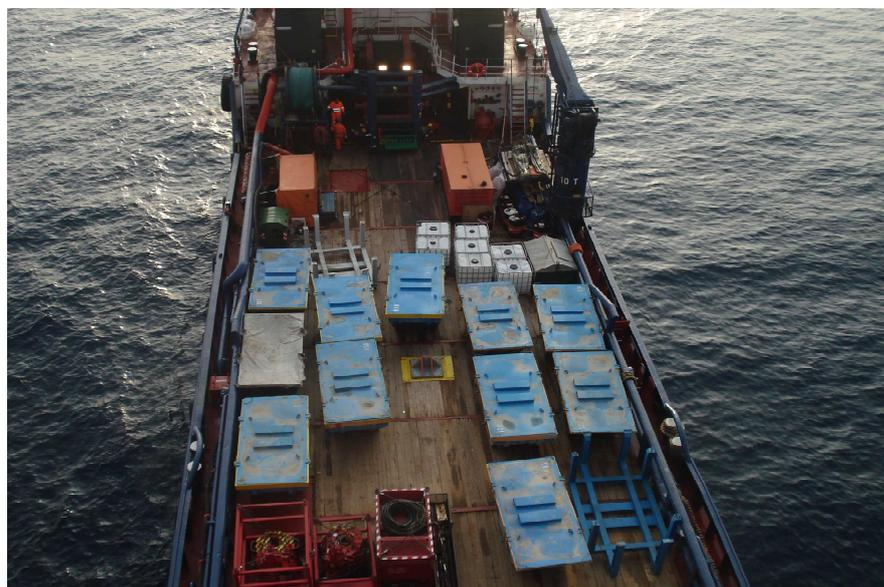
**Figura 3-25: trasporto a terra dei cassonetti tramite Supply Vessel**
