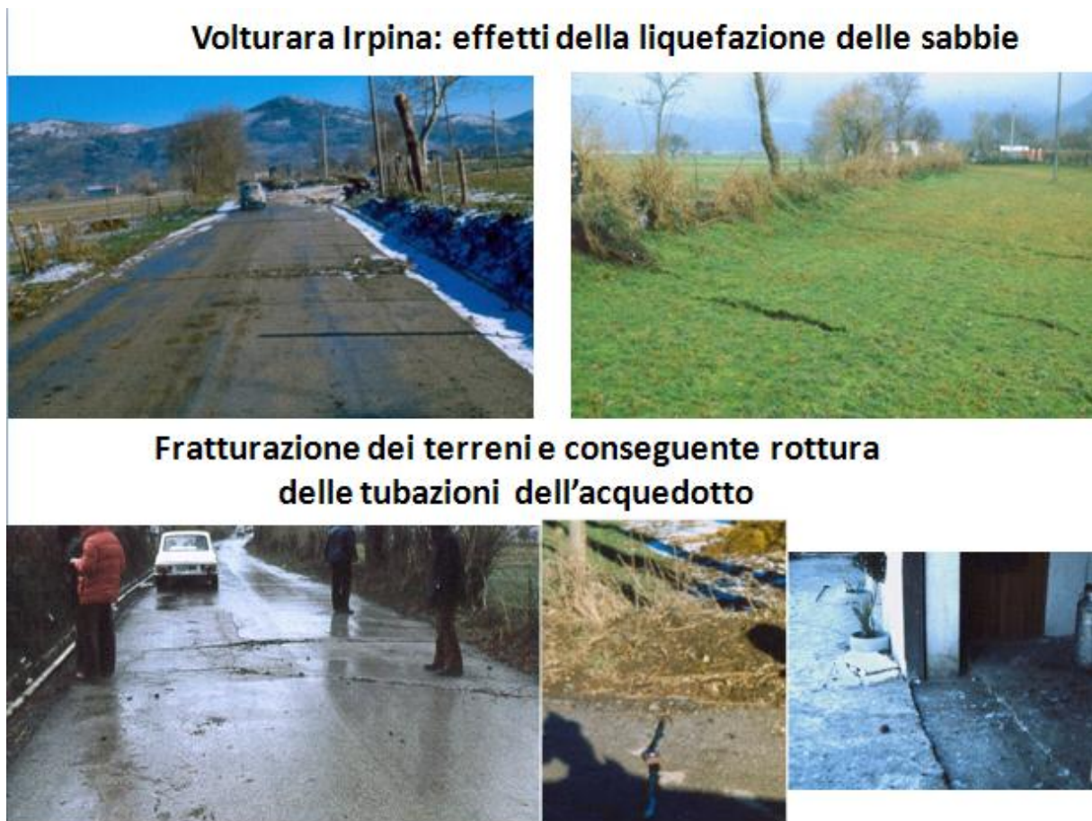
Fig. 31 - Fagliazione fino in superficie dei sedimenti sciolti (con fenomeni di liquefazione) nella Piana del Dragone nel Comune di Volturara Irpina. Le fratture hanno tranciato il tubo dell'acquedotto.
