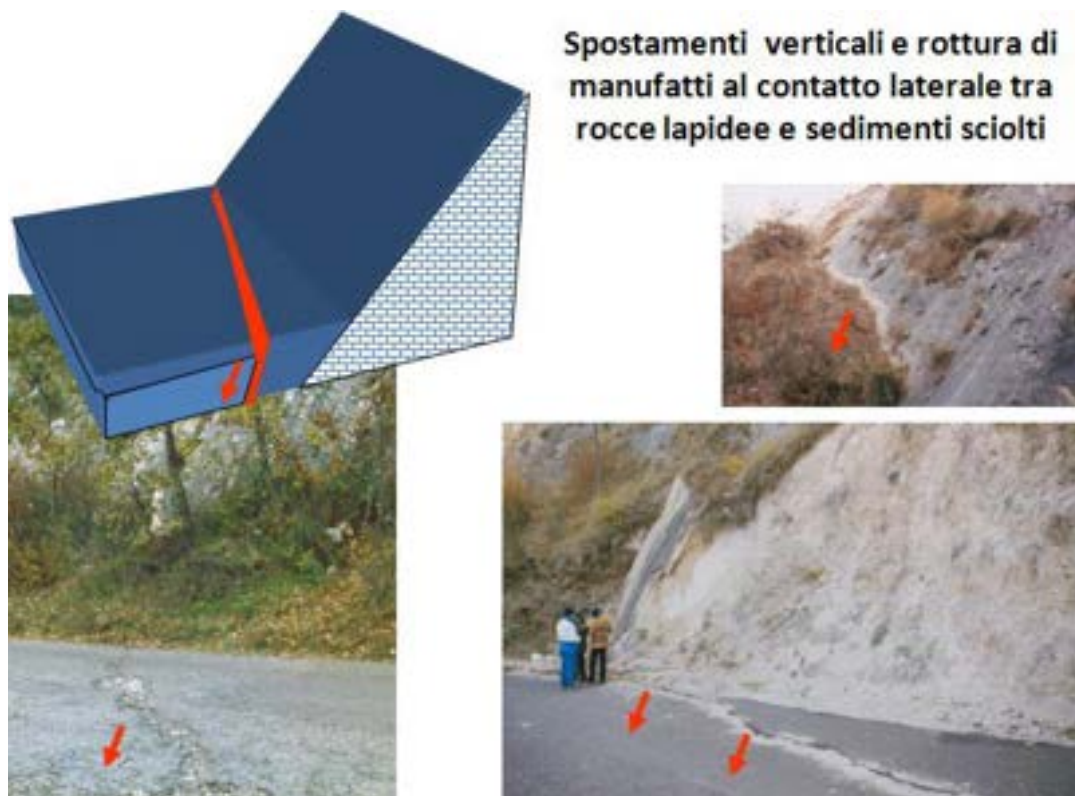
Fig. 33 - Spostamenti verticali tra blocchi contigui con differenti caratteristiche geomeccaniche rilevati in tutta l'area epicentrale.
