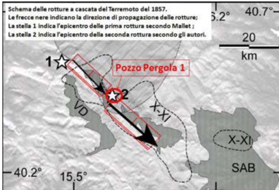
Fig. 21 - Ricostruzione della riattivazione a cascata delle faglie sismogenetiche della Valle del Melandro e dell'Alta Val d'Agri in occasione del sisma del 1857. La prima rottura si sarebbe verificata nella parte nord-occidentale della Valle del Melandro propagandosi verso Sud-Est nella zona dove è previsto il Pozzo Pergola 1. Proprio da questa zona sarebbe iniziata la riattivazione della seconda faglia. E' importante fare rilevare che le faglie propagandosi verso Sud-Est determinano una marcata direttività che causa, come è noto in letteratura, una accentuazione delle sollecitazioni sismiche che causano effetti locali altamente distruttivi e imprevedibili. E' evidente che il sito del Pozzo Pergola 1 rappresenta una zona che può essere interessata da effetti locali altamente distruttivi. A tale pericolosa situazione non viene fatto alcun riferimento nello studio VIA.
