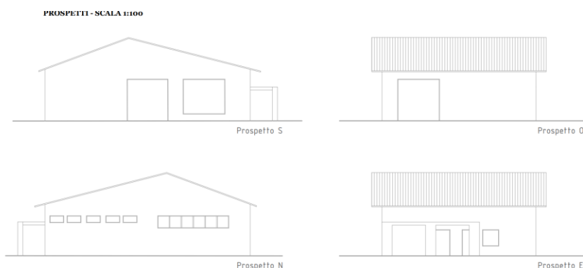
Figura 2. Particolari dei prospetti del capannone in progetto
