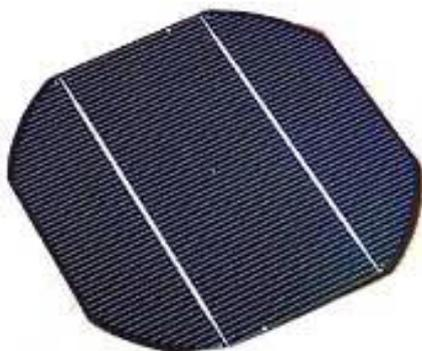
Figura 4 - Cella fotovoltaica in silicio monocristallino
