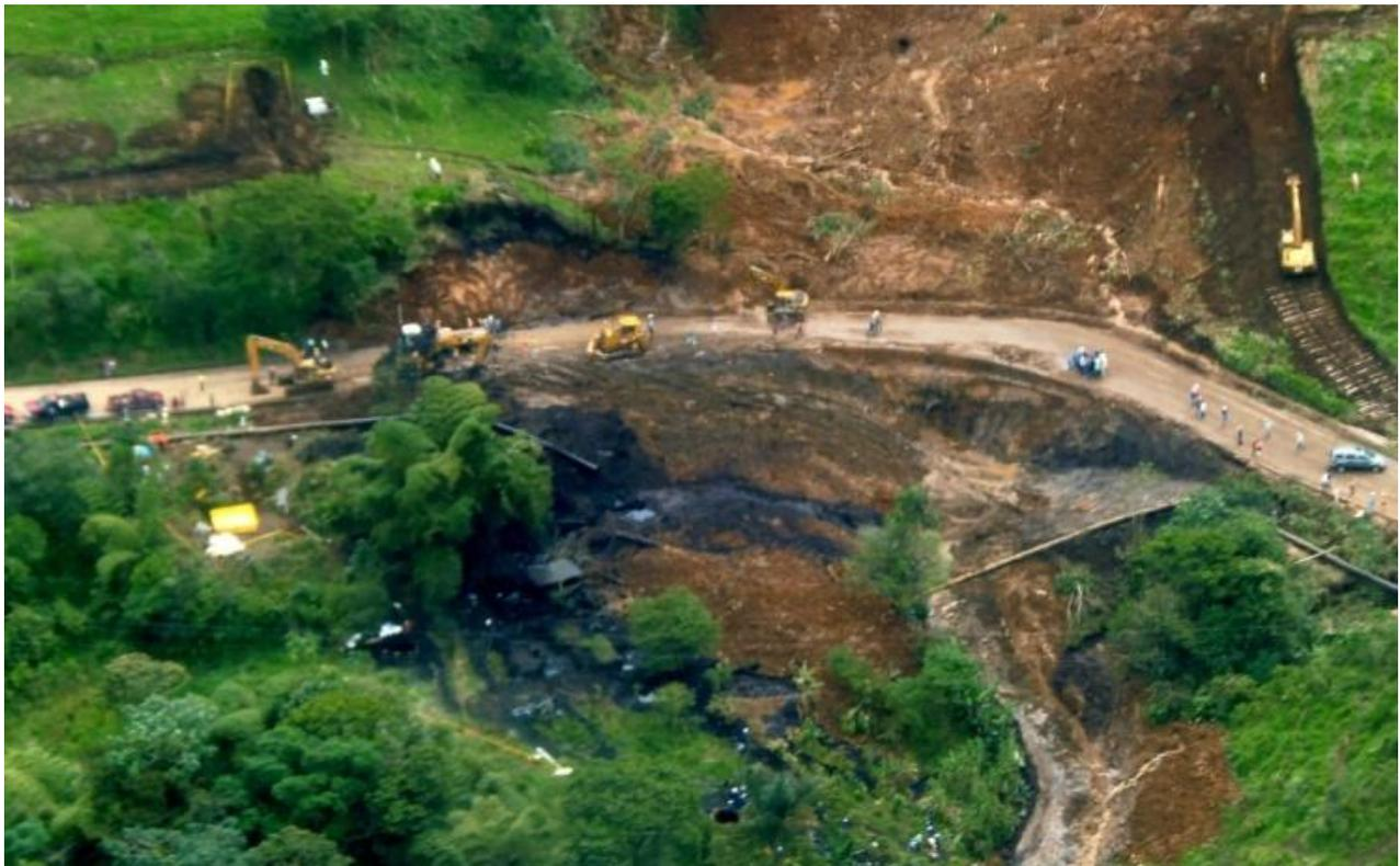
**Fig. 13 - Una frana in Ecuador ha coinvolto e rotto l'oleodotto Trans-Ecuador, causando la fuoriuscita di 205.000 litri di olio greggio e l'inquinamento del territorio circostante.**
