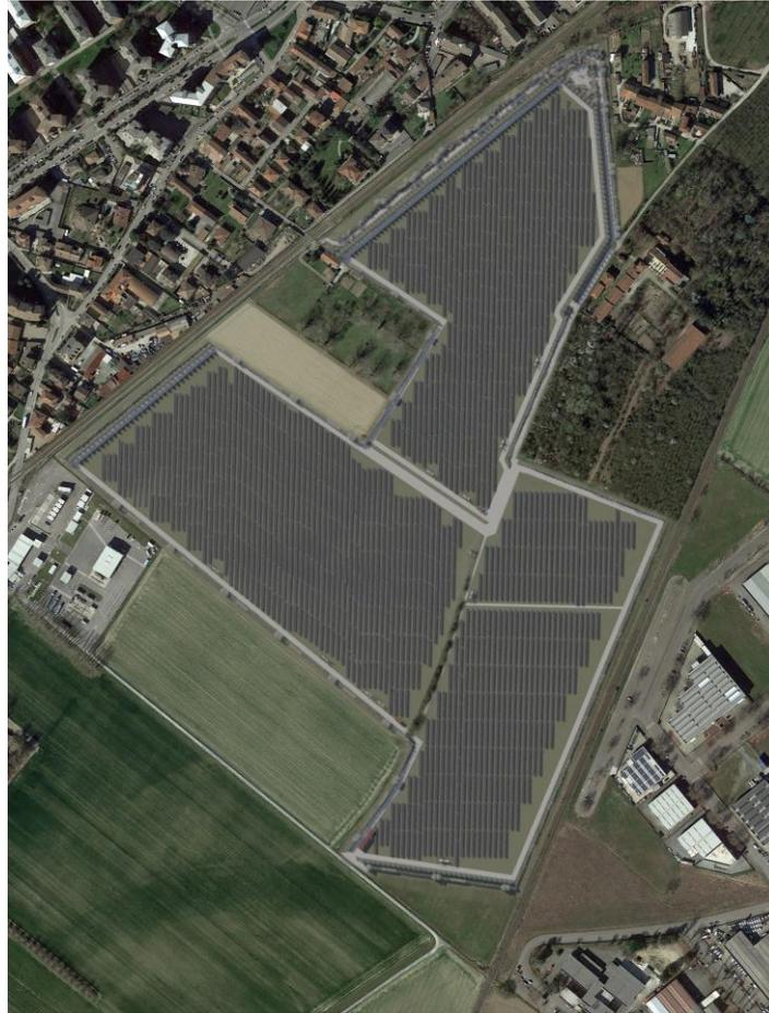
I pannelli saranno montati su strutture a inseguimento monoassiale (tracker) in configurazione monofilare ed ogni tracker (struttura portante dei pannelli) sarà composto da 24 moduli.
