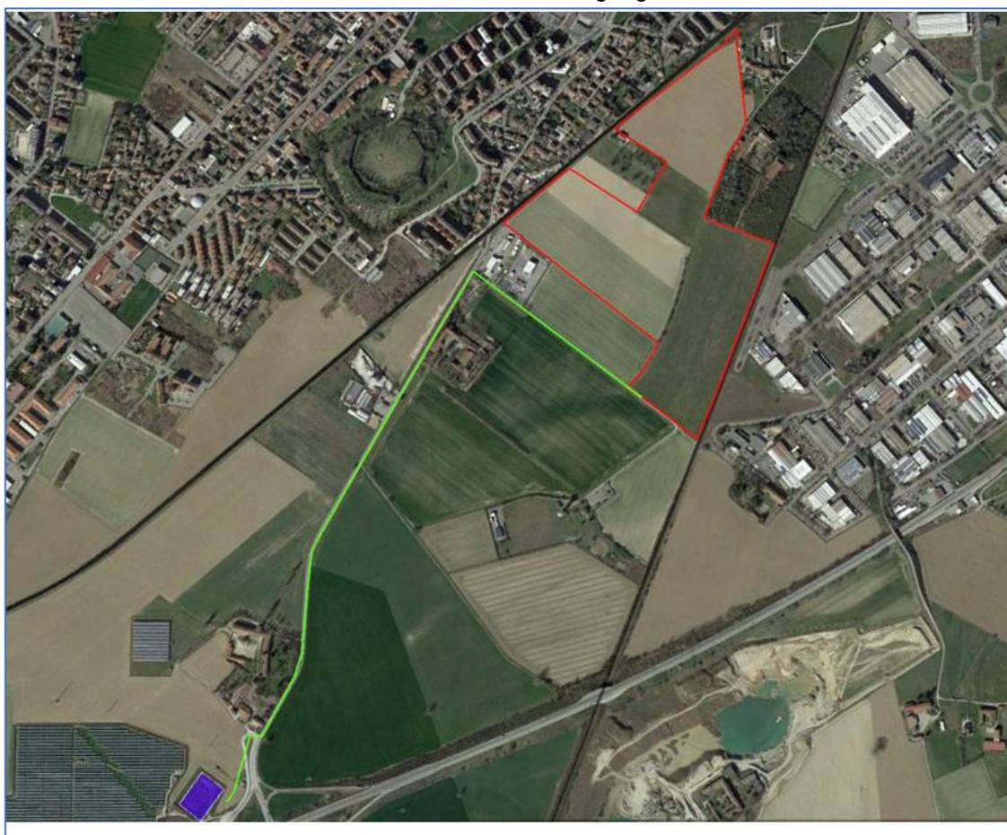
**FIGURA 1 - IMMAGINE SATELLITARI DELL'AREA OGGETTO DI INTERVENTO CON INDIVIDUAZIONE DELL'AREA DI INSTALLAZIONE DELL'IMPIANTO E DI CAVIDOTTO INTERRATO E CABINA DI CONSEGNA**
