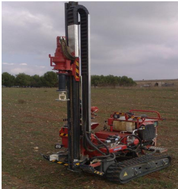
FIGURA 8 - MACCHINA BATTIPALO PER INFIESSIONE PALI.
