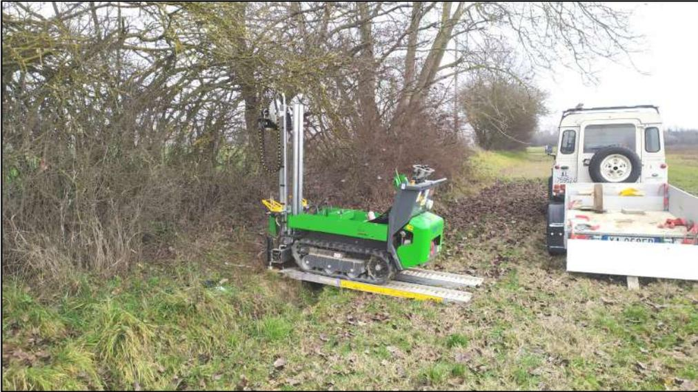
Foto n.1: Prova penetrometrica DPSH - PZ1
