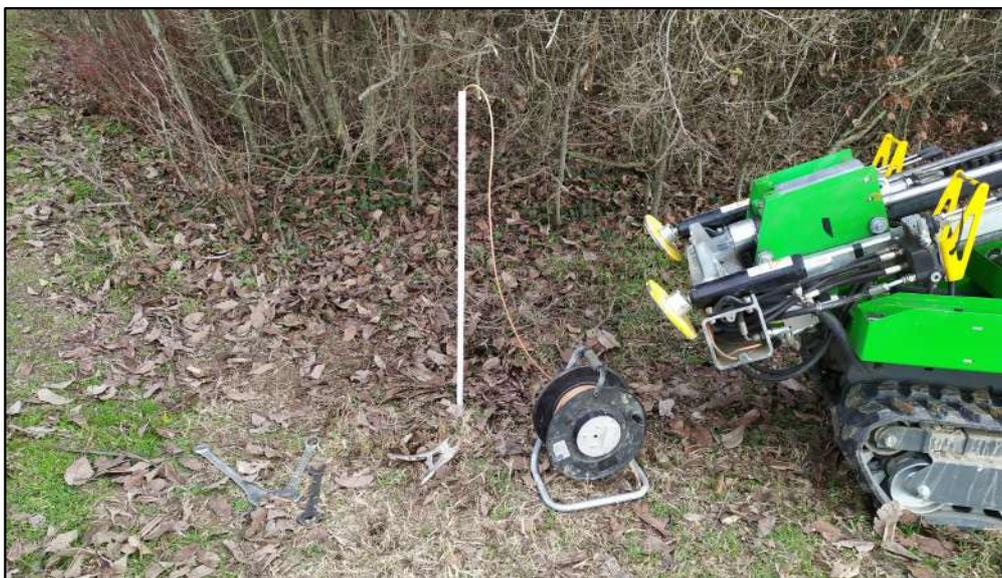
Foto n.6: Sonda freaticometrica all'interno della canna piezometrica. Profondità raggiunta dalla canna piezometrica -7,20m dal piano campagna. Misurazione del 27/01/2023: nessuna presenza di acqua libera (asciutto).
