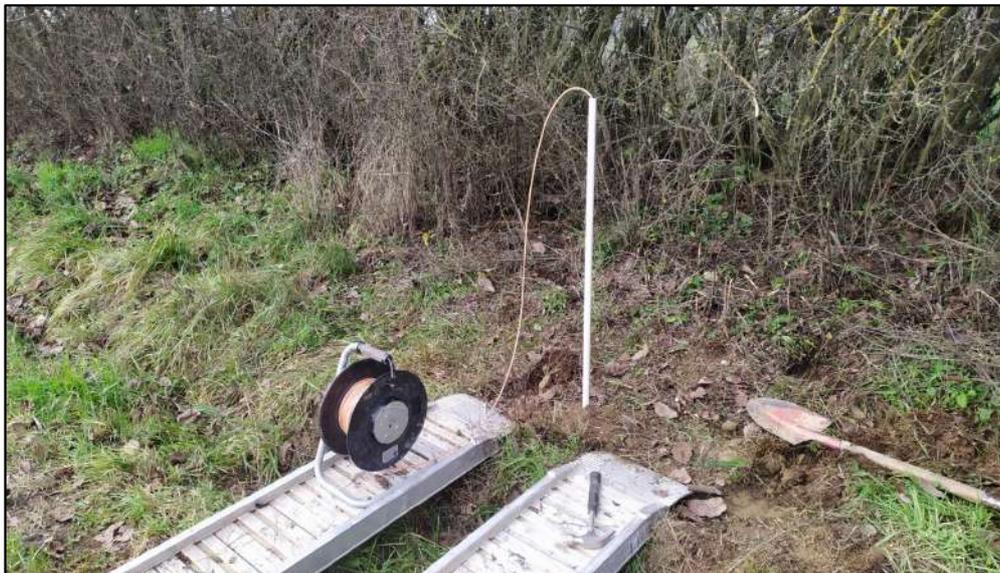
Foto n.3: Sonda freaticometrica all'interno della canna piezometrica. Profondità raggiunta dalla canna piezometrica -7,80m dal piano campagna. Misurazione del 27/01/2023: nessuna presenza di acqua libera (asciutto).
