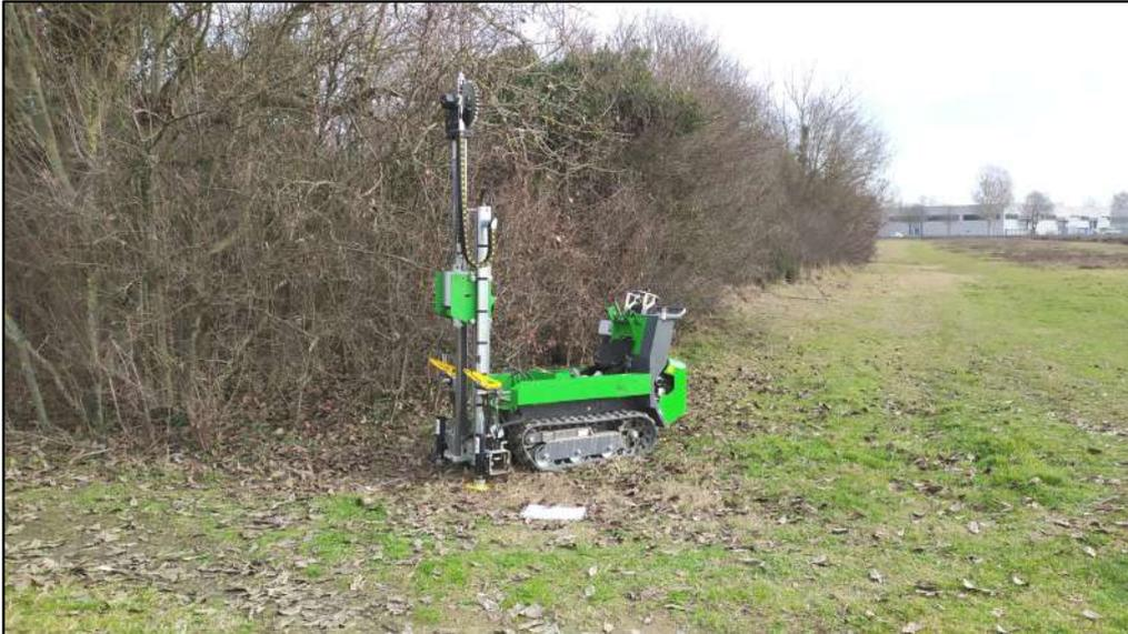
Foto n.4: Prova penetrometrica DPSH - PZ1
