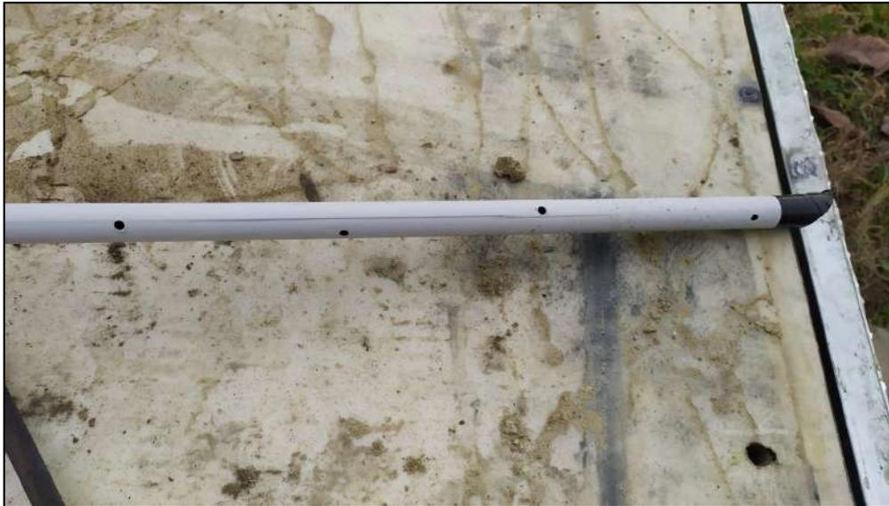
Foto n.2: Particolare parte terminale della canna piezometrica. I fori sono stati praticati in corrispondenza degli ultimi 3m
