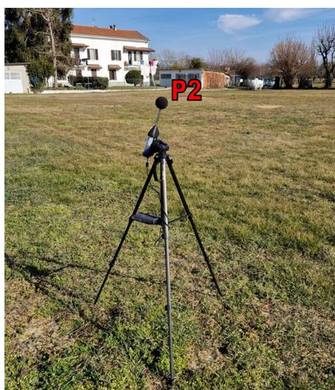
Le misure sono state effettuate seguendo le indicazioni del DM 16/03/1998, ossia in condizioni meteorologiche buone ed in assenza di fenomeni perturbativi o precipitazioni atmosferiche, posizionando il microfono ad almeno un metro di distanza dalle eventuali superfici riflettenti e a circa 1.5 metri da terra. Lo strumento è stato calibrato prima e dopo i rilievi, verificando che lo scarto tra le due misure risultasse inferiore a 0.5 dBA.
