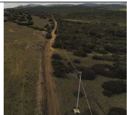
Potenziali interferenze con manufatti per linee elettriche sui tracciati per le wtg ESC10 e ESC13
