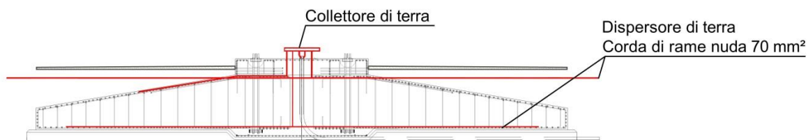
Figura 25 - Schema tipo impianto di messa a terra di un aerogeneratore
