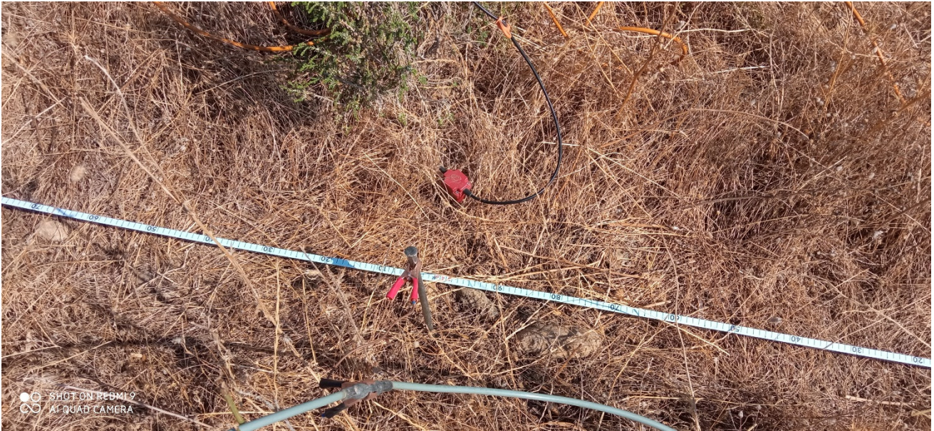
Foto 4 Particolare di picchetto e geofono affiancati per MASW3 e geoelettrica
