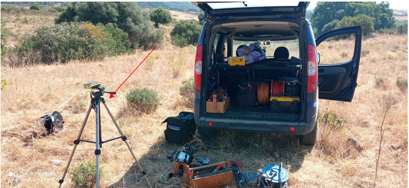
Foto 5 Evidenza del DISTO per l'acquisizione delle quote relative dei picchetti per le correzioni topografiche
